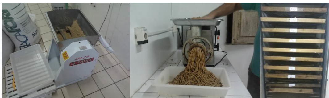
Figura 05 - Etapas de preparo da ração com a mistura dos ingredientes, peletização e secagem em estufa.
