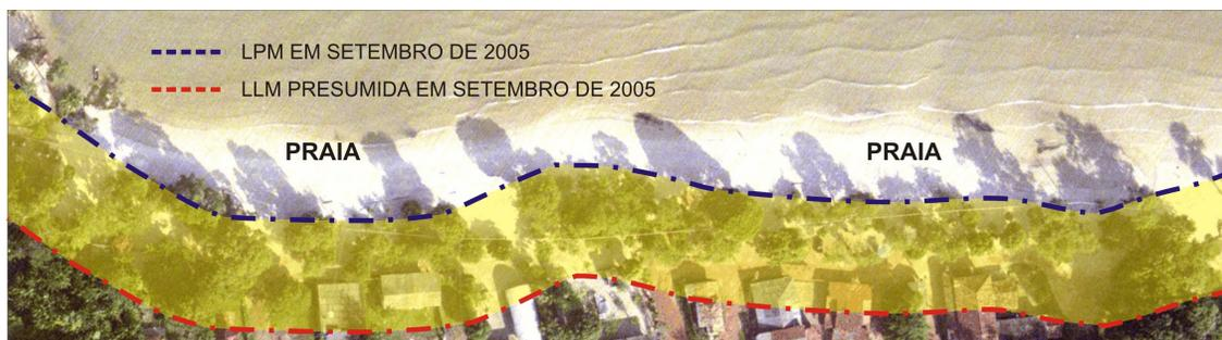
Figura 111 – LPM e LLM presumido em setembro de 2005. LPM determinado pelo levantamento topográfico feito à época do projeto. Foto da área antes da intervenção demonstrando as edificações sobre o perfil e provavelmente em áreas de União.
