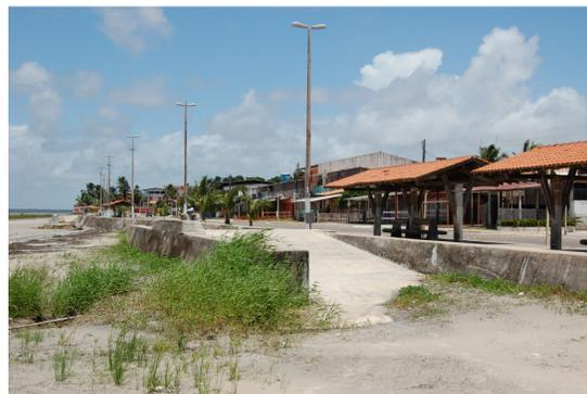
Figura 52 – Deposição de sedimentos à base da Rampa 2 devido à ação eólica. Marudá, maio de 2009.
