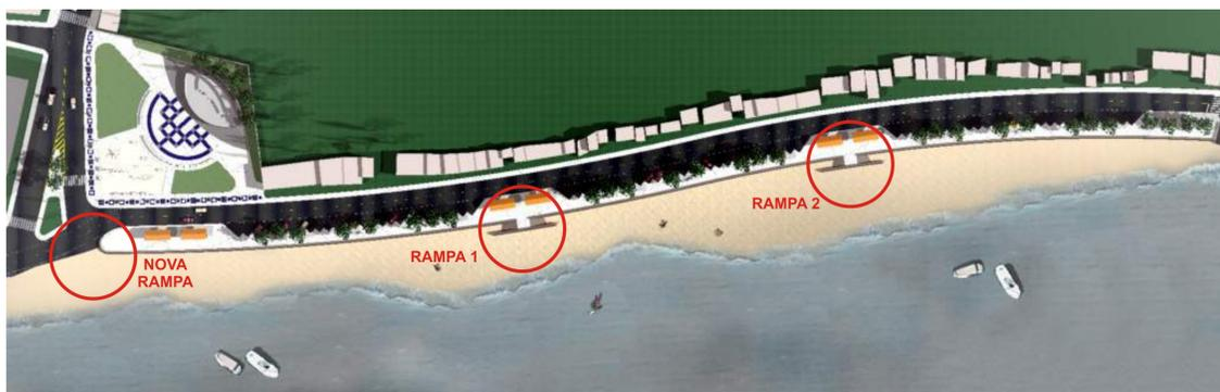
Figura 42 – Vista geral do projeto. Sistema viário e muro de contenção paralelos à linha dos lotes. Posicionamento das Rampas 1, 2 e da Nova Rampa, construída posteriormente. Marudá, julho de 2006.
