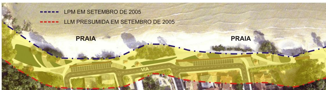
Figura 112 - LPM e LLM presumido em setembro de 2005. LPM determinado pelo levantamento topográfico feito à época do projeto. Foto aérea montada com a maquete eletrônica do projeto. Obra executada na faixa da União.
