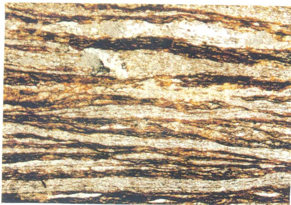
Figura 5.12: Estrutura bandada, definida pela alternância de níveis quartzosos e níveis com predominância de biotita e oxi-hidróxidos de ferro; amostra do biotita-xisto milonítico aflorando no igarapé do sítio da Cachoeira, em Santa Luzia; nicóis paralelos, 2,5x.
