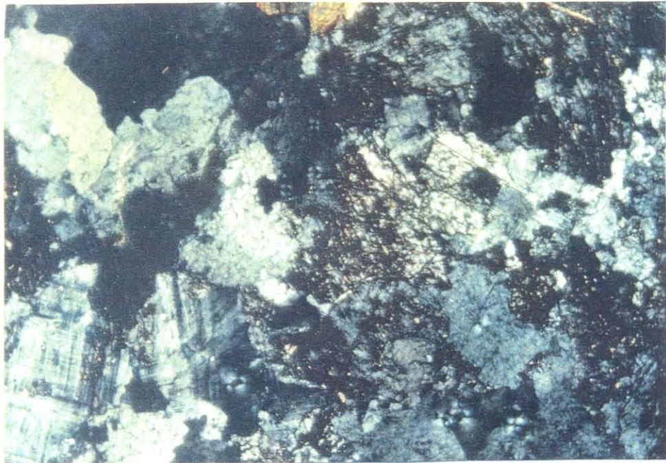
Figura 5.16: Alteração da albita em caolinita e preservação do microclínio; amostra coletada próxima à nascente da pedreira do Cigano; nicóis cruzados, 2,5x.
