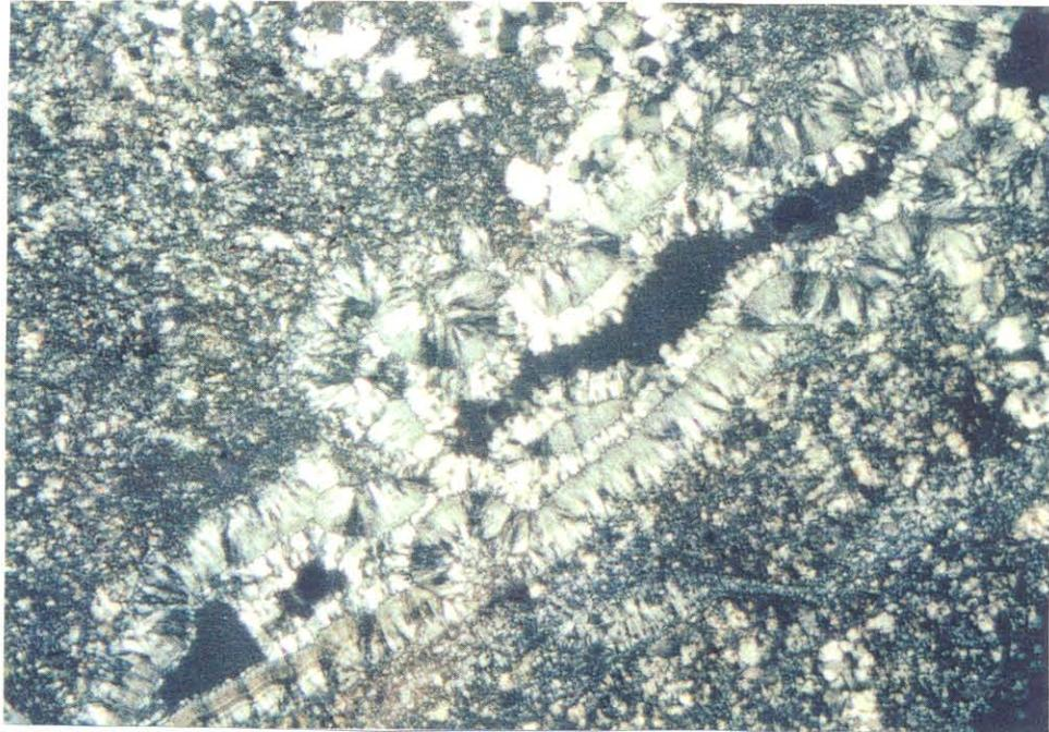
Figura 5.8: Veio de quartzo cortando clorita-chert. Os cristais são orientados perpendicularmente às paredes dos espaços preenchidos; amostra coletada na base da serra do Piriá; nicóis cruzados, 2,5x.
