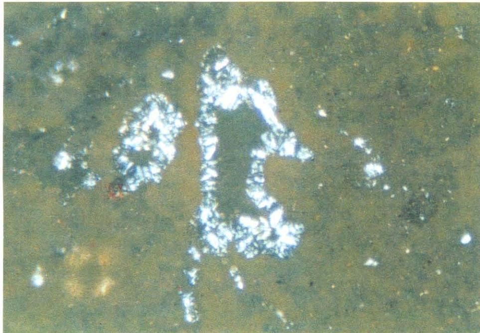
Figura 5.2: Franja de cristais de gibbsita orientados perpendicularmente às paredes de cavidade. O núcleo é ferruginoso, criptocristalino; amostra de laterita do topo da serra do Piriá; nicóis cruzados, 10x.
