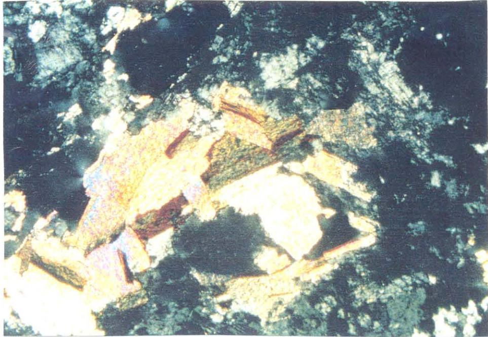
Figura 5.15: Transformação de biotita em clorita; amostra de granito aflorando próximo à nascente da pedreira do Cigano, em Tracuateua; nicóis cruzados, 2,5x.
