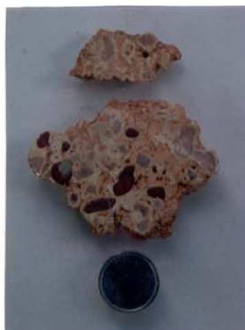
Figura 5.4: Fragmentos da crosta intemperizada onde se identificam os nódulos ferruginosos e os nódulos do fácies rosado cimentados pelo fácies creme além da matriz argilosa ocre que envolve os relictos (material agregado com resina).
