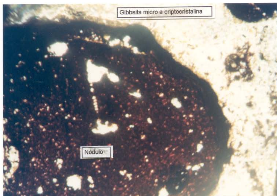
Figura 4.7: Aspecto dos nódulos de metapelite da crosta parcialmente intemperizada onde se individualizam os nódulos ferruginosos com borda mais escura de óxi-hidróxidos e poros preenchidos por gibbsita. 1\text{cm}=0,7\text{mm} .pn111
