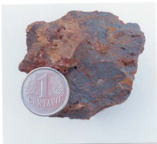
Figura 4.3: Fragmento de gossan de cor cinza com fraturas preenchidas por material argiloso ocre. Material da crosta intemperizada do perfil 1.
