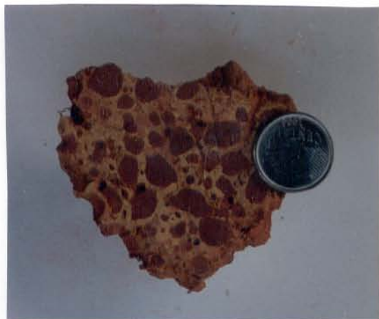
Figura 3.5 Aspecto nodular da crosta parcialmente desagregada do perfil 1 onde se identificam os nódulos ferruginosos envolvidos pelo cimento ocre.
