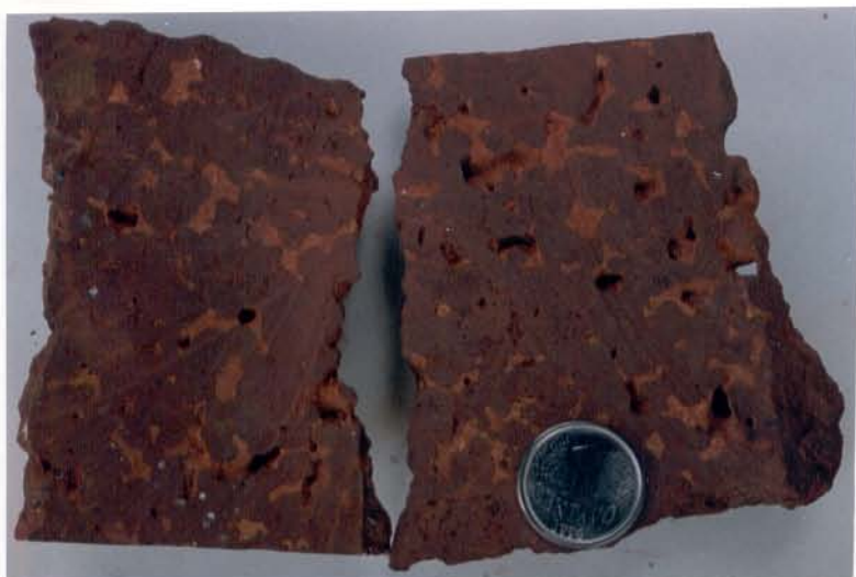
Figura 3.3: Aspecto macroscópico da crosta sã do perfil 1 de N5 onde se identificam o material ferro-aluminoso marrom-avermelhado com incipiente textura nodular e o material argiloso ocre-avermelhado preenchendo os vacúolos.
