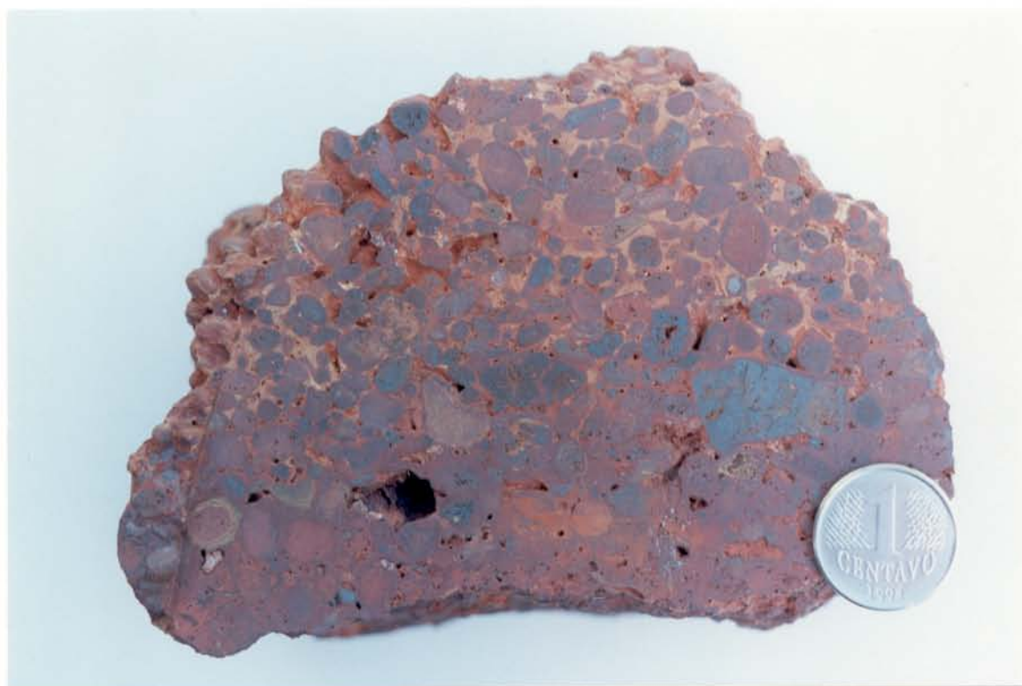
Figura 4.5: Aspecto nodular dos fragmentos da crosta parcialmente intemperizada onde se identificam os nódulos de gossan de cor cinza e os de metapelite lateritizada avermelhados envolvidos pelo cimento ocre.
