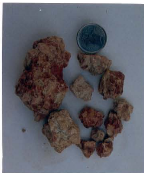
Figura 6.5: Aspecto mosqueado da porção intermediária do solo de Mosqueiro onde se identifica o material amarelado manchado por óxi-hidróxido de ferro (1,5m).
