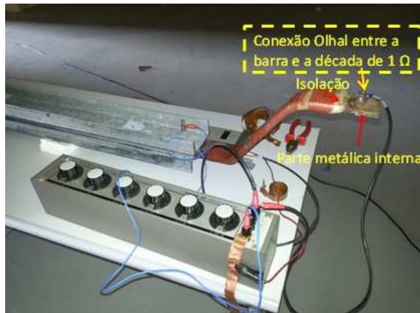
Figura 4.12 – Conexão do gerador de pulsos e da década resistiva à barra.
