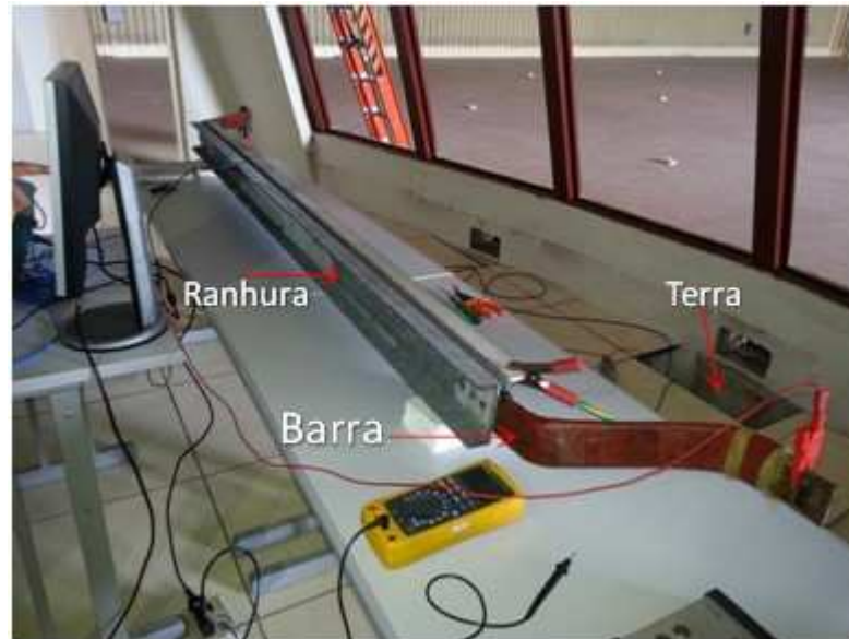
Figura 4.10 – Barra, ranhura e acesso ao local de aterramento do experimento.
