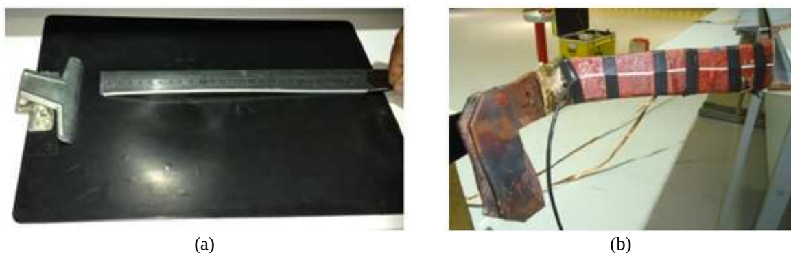
(a) (b) Figura 3.13 – (a) Cabo coaxial utilizado no estudo; (b) Utilização do cabo coaxial como antena.
