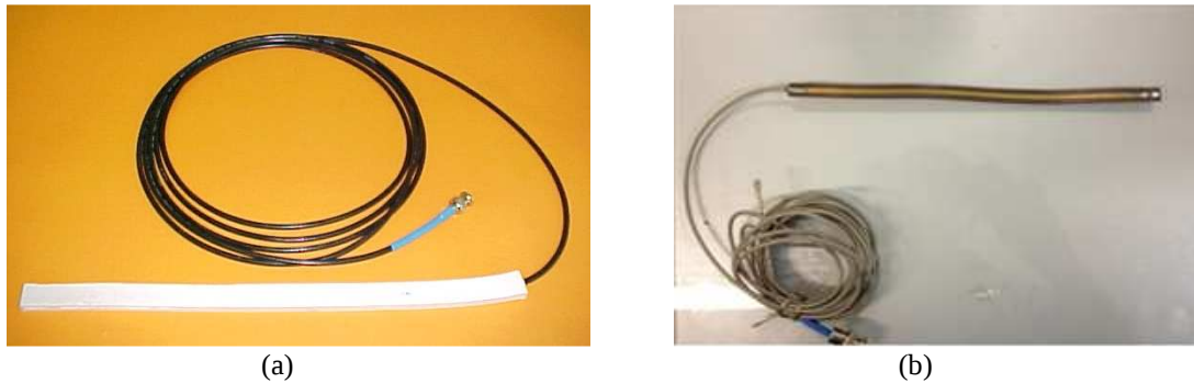
Figura 3.9 – (a) Sensor encapsulado em silicone, (b) Sensor sem encapsulamento.
