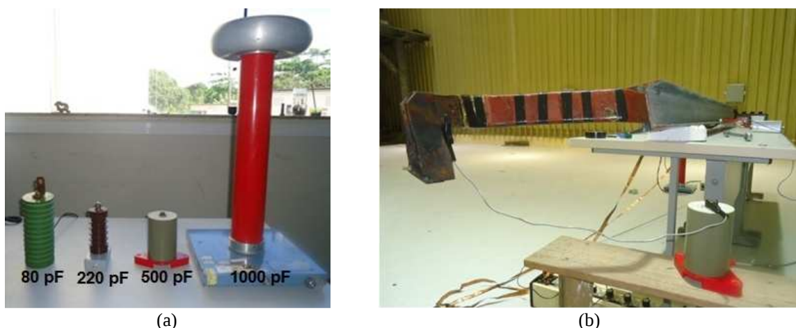
Figura 3.11 – (a) Acopladores utilizados no estudo; (b) Utilização do acoplador de 500 pF.
