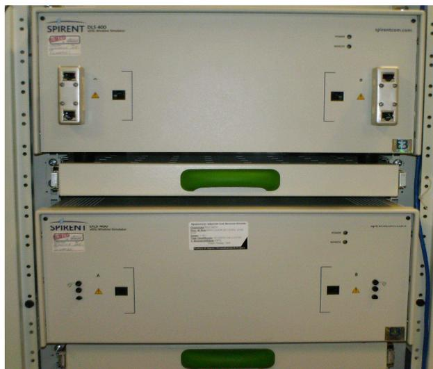
**Figura 3.2:** Simulador de Linha ADSL 400E3.
