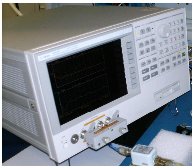
**Figura 3.6:** Analisador de impedância de precisão 4294A.
