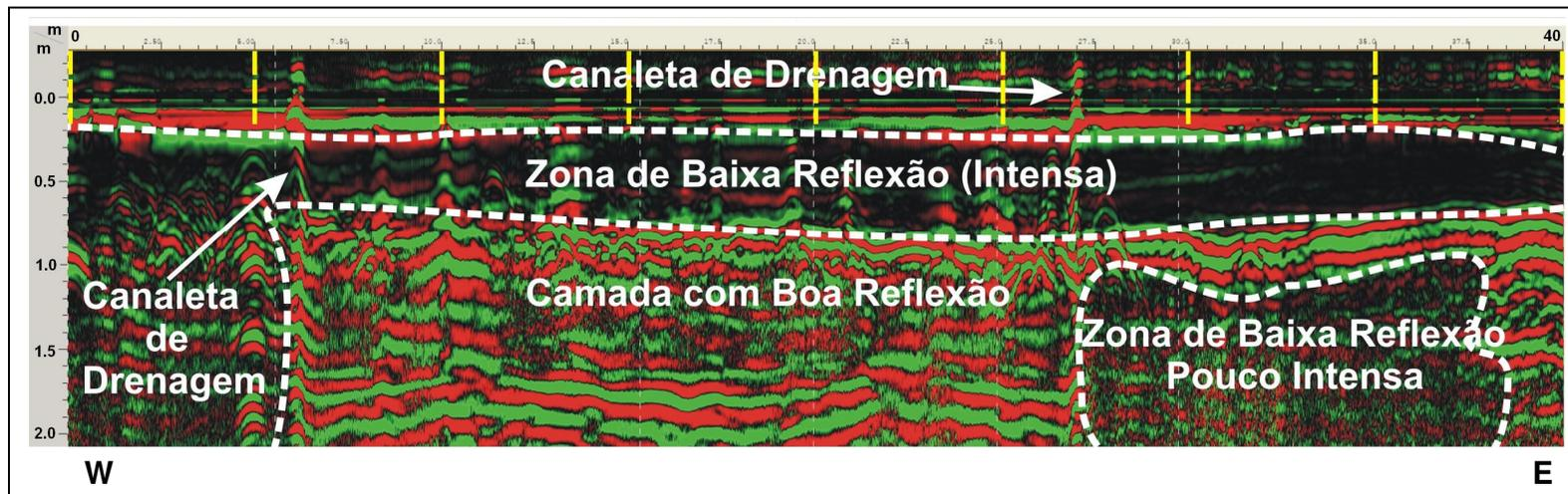
Figura 9.27 – Perfil 24 realizado no posto Carvalho III, mostrando o contraste lateral entre a zona de baixa reflexão e camada de boa reflexão.
