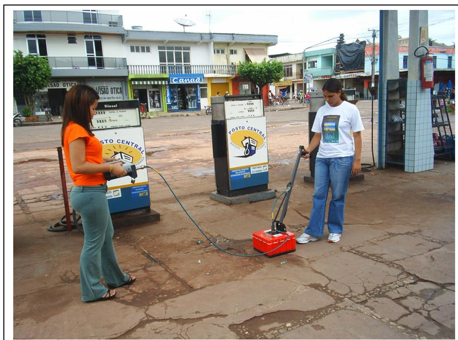
**Figura 9.3 – Levantamento com GPR realizado paralelo às bombas de combustíveis.**
