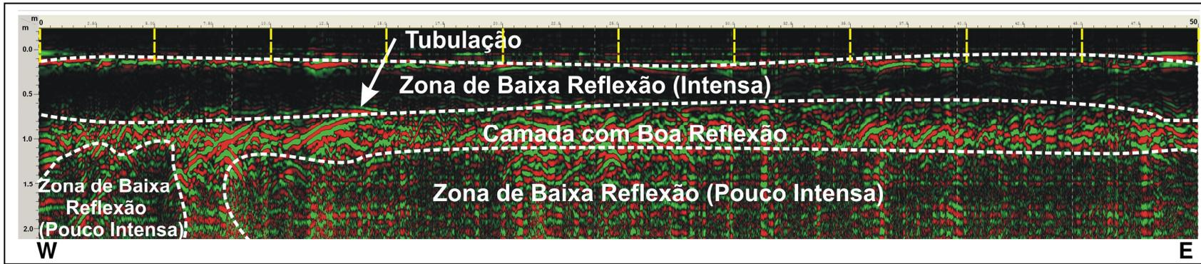
Figura 9.13– Perfil 17 realizado no posto Carvalho I em Abaetetuba, mostrando a variação vertical da camadas e a presença de bolsões de baixa reflexão.
