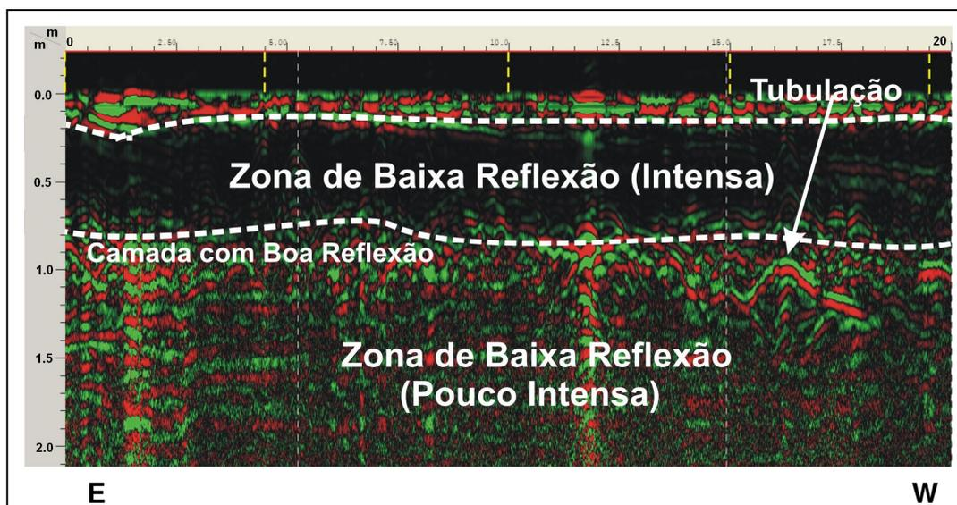
Figura 9.11 – Perfil 12 realizado no posto Central em Abaetetuba, mostrando a presença de zonas de baixa reflexão.
