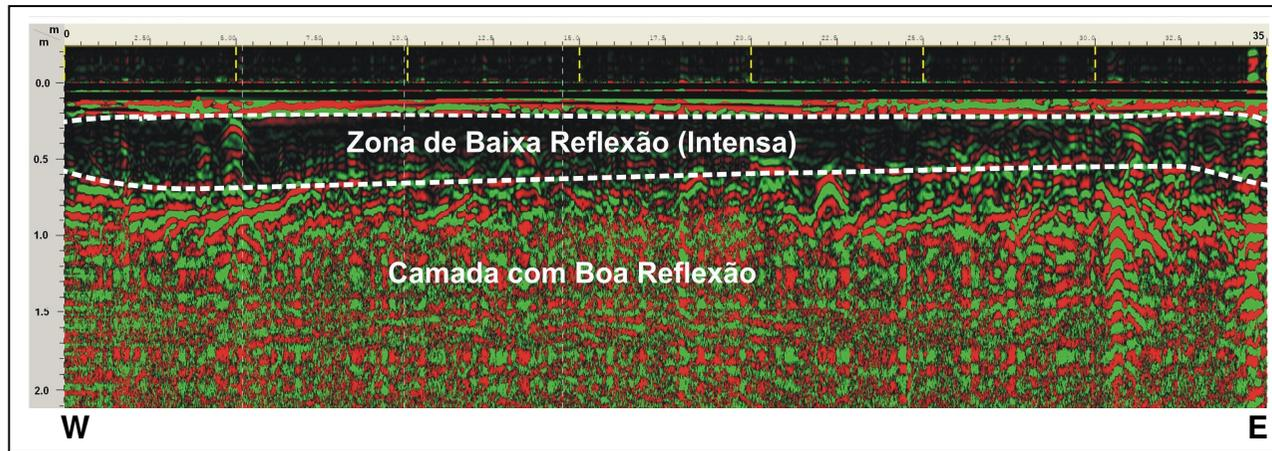
Figura 9.33 – Perfil 15 mostrando uma zona de baixa reflexão na parte superior do perfil, seguida uma camada de boa reflexão.
