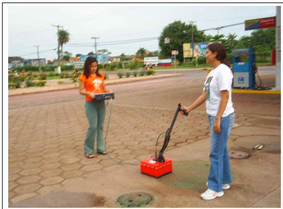
**Figura 9.4 – Levantamento com GPR realizado perpendicular aos tanques subterrâneos de combustíveis.**
