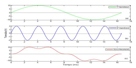
Figura 2 - Tensão normal adicionada da 5ª harmônica resultando o sinal distorcido.
