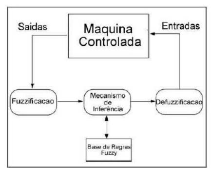
Figura 7 - Modelo de um sistema de inferência Fuzzy.
