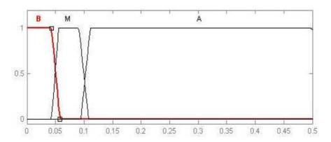
Figura 14 - Função de pertinência da variável THD\_U.
