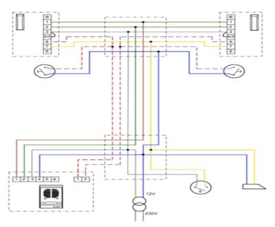
Figura 10 - Exemplo de um diagrama multifilar.
