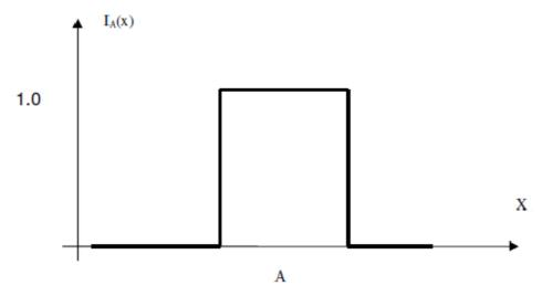
Figura 4 - Função indicadora de A.
