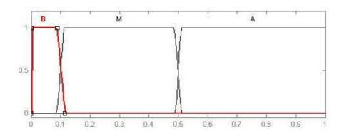
Figura 15 - Função de pertinência da variável THD\_I.
