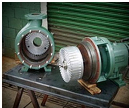
Figura 6: Moinho coloidal utilizado no processo produtivo de emulsão asfáltica [5].
