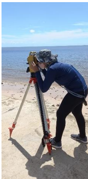
Figura 8. Medição topográfica utilizando Estação Total. Fonte: Autor.
