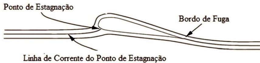
**Figura 1.3: Visualização esquemática sobre a seção transversal de uma pá. Adaptado de Hansen (2008)**
