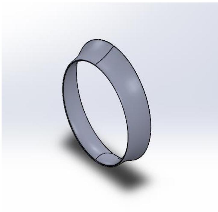
**Figura 3.5 - Difusor Eppler 423 vista isométrica (Fonte: Autoria própria).**
