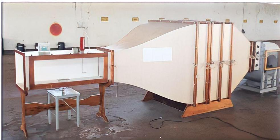
**Figura 3.1 - Túnel de vento (Fonte: Silva, 2018).**
