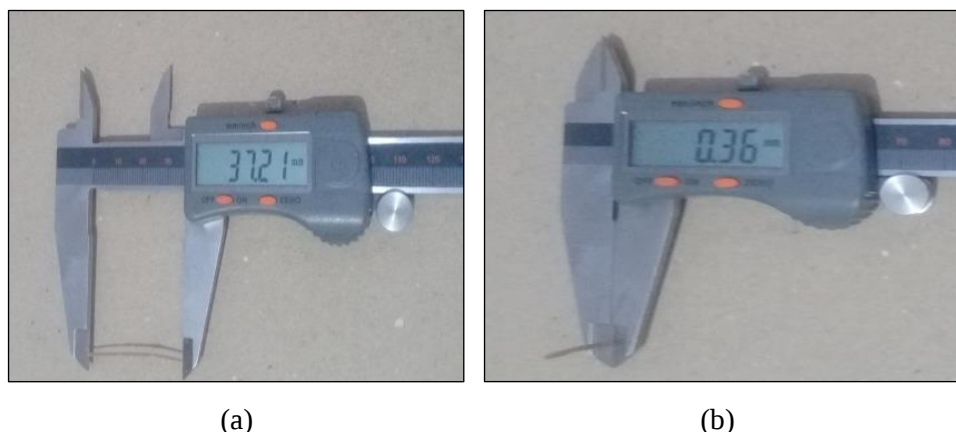
Figura 3.5– Ensaio de caracterização realizado com paquímetro. (a) Comprimento da fibra do bambu; b) Diâmetro da fibra de do bambu. Fonte: Autor.
