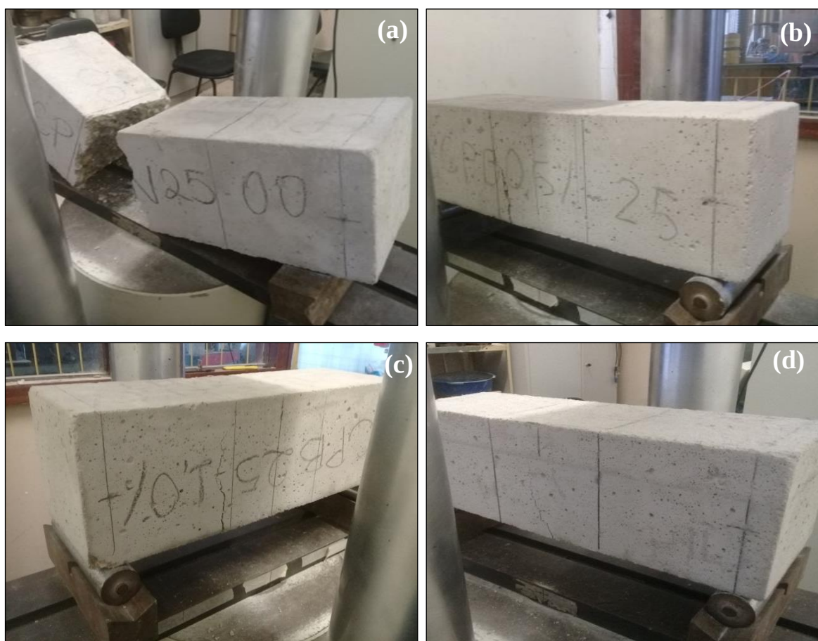
Figura 3.25- Ensaio de resistência à tração na Flexão segundo JSCE SF4. Fonte: Autor.
