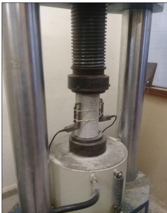
Figura 3.21- Ensaio para determinação do módulo de elasticidade tangente inicial ( E_{ci} ) Fonte: Autor.
