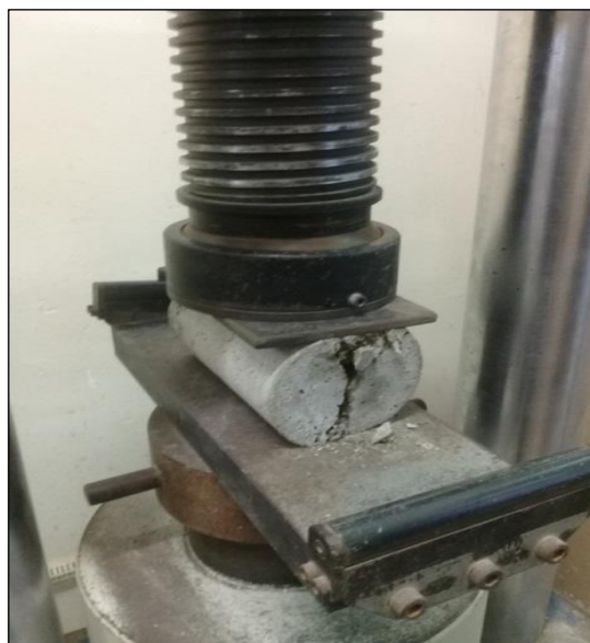
Figura 3.23- Ensaio de resistência à tração por compressão diametral ( f_{ct} ). Fonte: Autor.
