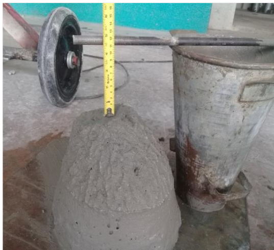
Figura 3.14- Ensaio de abatimento de tronco de cone. Fonte: Autor.
