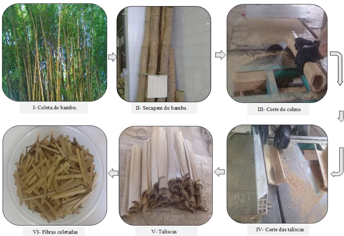
Figura 3.3 - Processo de obtenção da fibra de bambu. Fonte: (Autor).
