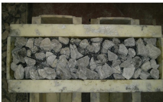
Figura 1.2 – Concreto em dois estágios reforçado com fibras de aço antes do lançamento do grout . (NEHDI, et al. , 2017).
