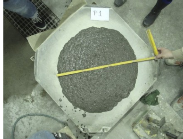
b) Espalhamento do concreto
