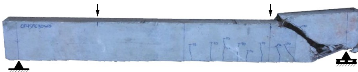
Figura 7.3 – Viga CF45W0 (ruptura por cisalhamento).
