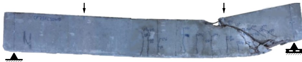
Figura 7.5 – Viga CF75W0 (ruptura em flexão pura).
