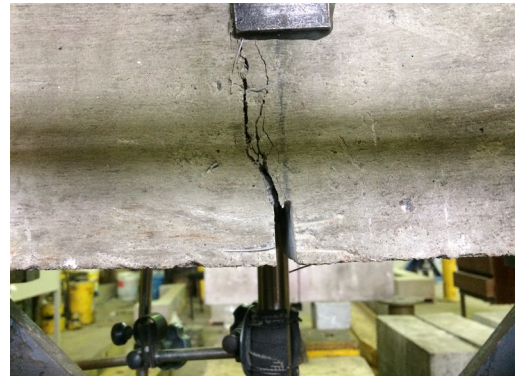
b) Prisma entalhado fissurado, ao fim do ensaio
