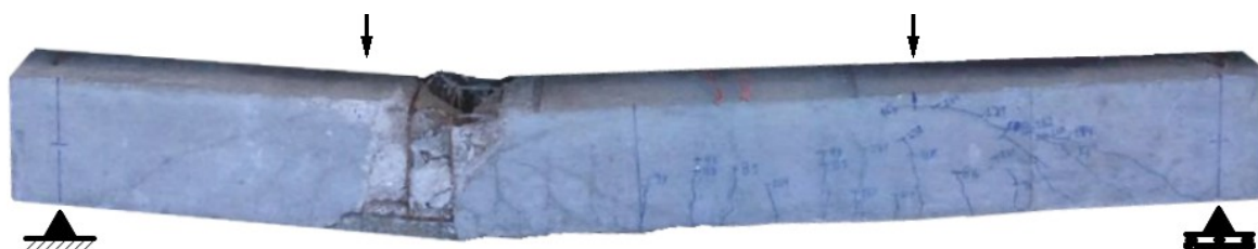
Figura 7.2 – Viga CF0W13 (ruptura em flexão pura).
