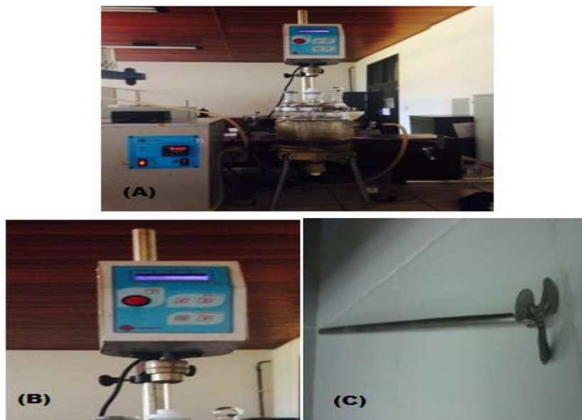
Legenda: (A) Sistema extrator de vidro e banho termostático, (B) Agitador e (C) Hélice do agitador.
