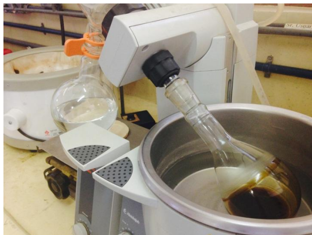
Figura 12: Destilação em rota evaporador em funcionamento
