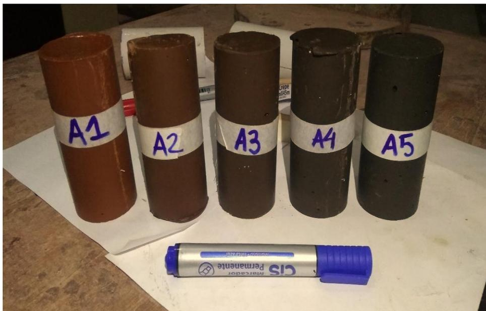
Figura 3.7 - Corpos de prova desmoldados, de geopolímeros a base de argila do Rio Guamá.
