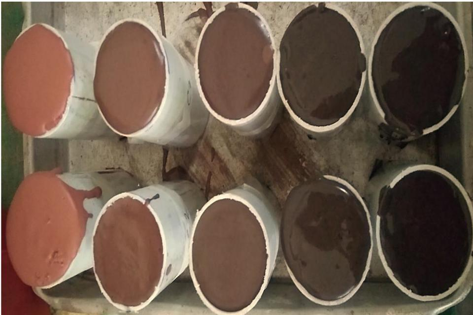
Figura 3.6 - Corpos de prova moldados, de geopolímeros a base de caulim ferrítico.
