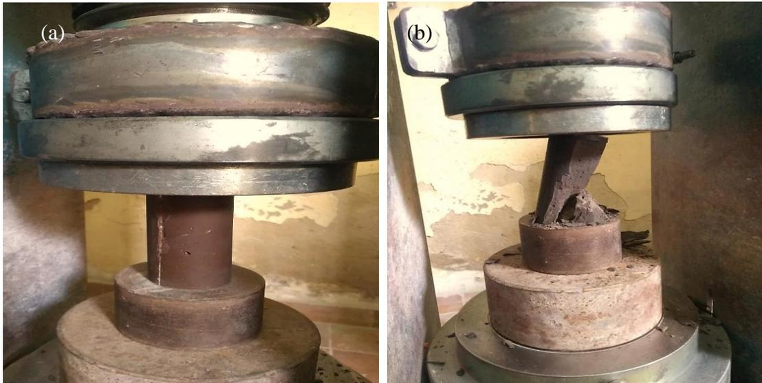
Figura 3.10 - Corpo de prova geopolimérico na prensa (a) e amostra A-5 fraturada (b).
