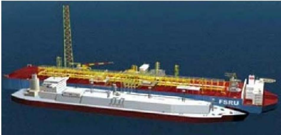
Figura 4.3 - Terminal flutuante utilizando um navio de GNL ancorado convertido para estocagem com regaseificador a bordo (do tipo FSRU).
