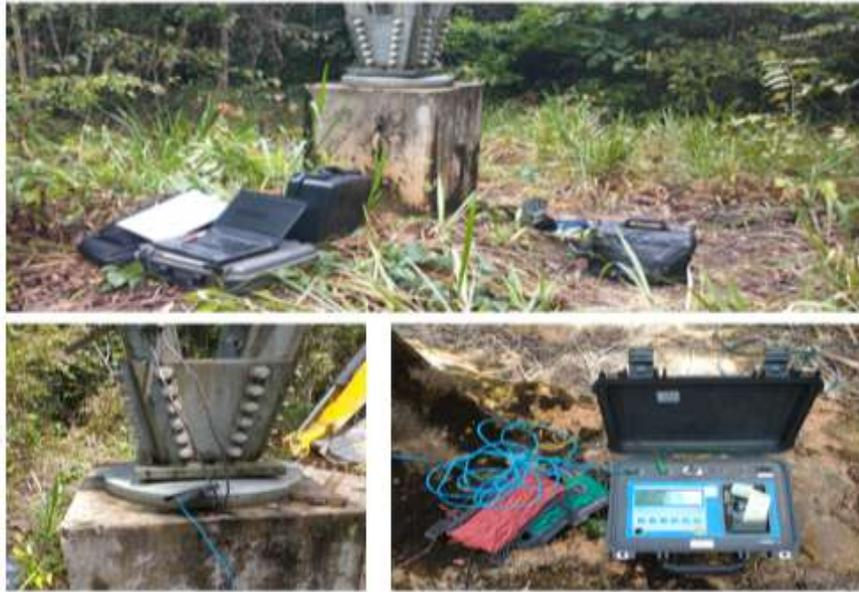
Figura 4.13 - Realização de ensaios de medição de resistência.
