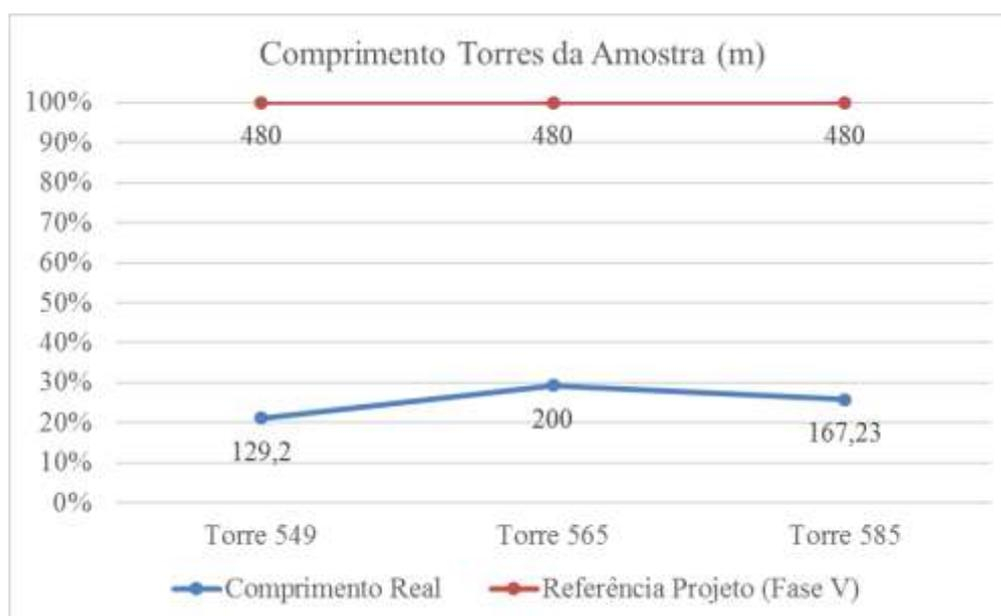
Figura 4.8 - Comprimento dos cabos de aterramento real e o especificados no projeto da - LT Oriximiná – Silves CD.
