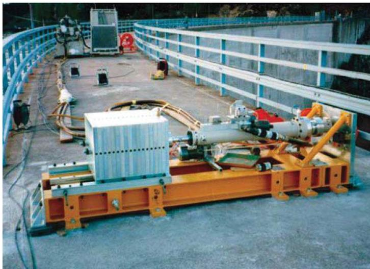
**Figura 1.2. Vibrador servo-hidráulico em ensaio de barragem. (CUNHA; CAETANO, 2006)**
