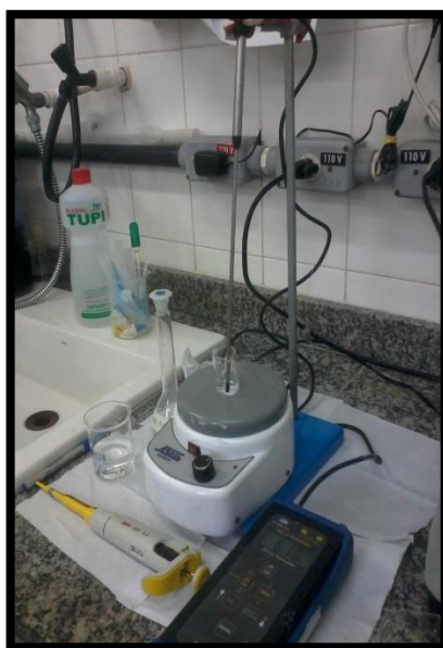
Figura 12 - Instrumentação para titulação potenciométrica de pequenos volumes de água intersticial.
