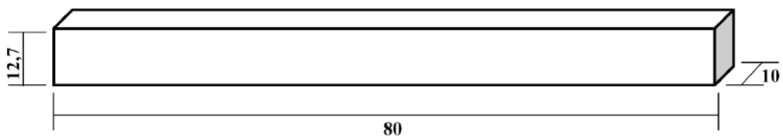
Figura 3.16 – Esquemático, em mm, dos corpos de prova para ensaios de impacto
