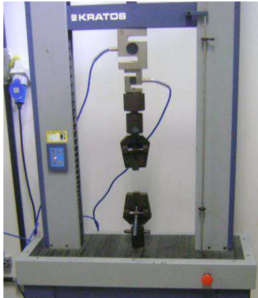
Figura 3.13 – Máquina universal de ensaio, utilizada para os ensaios de tração dos compósitos produzidos
