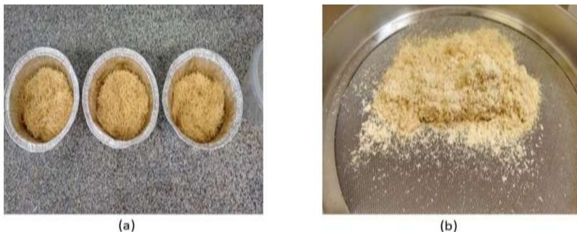
Figura 3.7 – (a) Fibras de bambu lavado (b) Fibras de bambu moído.
