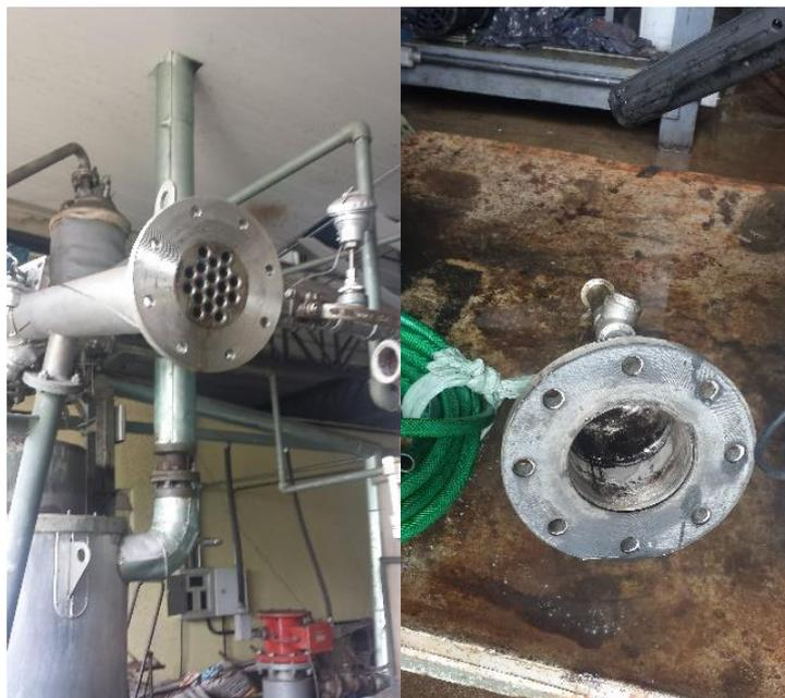
**Figura A.1** – Limpeza dos tubos internos do condensador da planta piloto de craqueamento.
