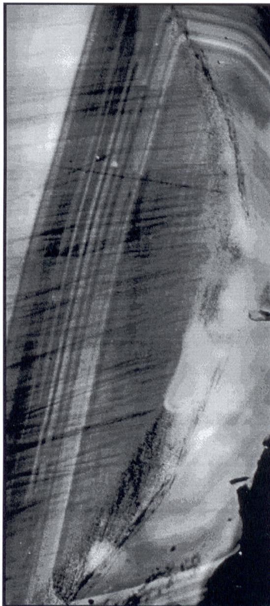
Estrutura interna, mostrando uma figura simétrica formada por bandas claras (provável nitrogênio) e escuras (provável boro). Os riscos transversais representam vestígios do polimento, na ocasião da preparação da amostra. A estrutura é atravessada por uma fratura. Aumento 400x
