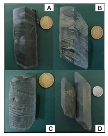
Figura 4 - Aspectos mesoscópicos dos filitos presentes no Alvo Enche Concha. A) Filito com coloração preta esverdeada intensa que apresenta bandamento hidrotermal; B) Filito com feições amendoadas de cristais de plagioclásio alterados para carbonato, evidenciando deformação; C) Filito bandado com porções levemente carbonatadas; D) Filito com pequenos cristais de sulfeto.
