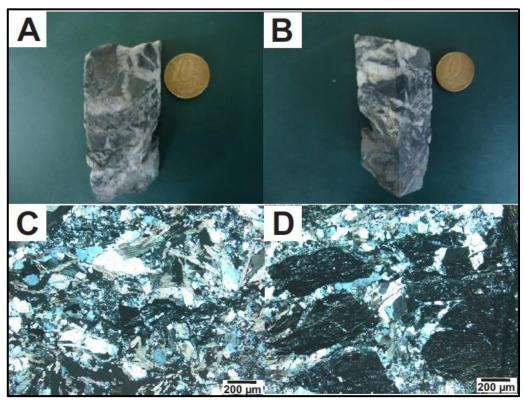
Figura 8 - Aspectos mesoscópicos e fotomicrografias das zonas de brecha, estas últimas com nicóis cruzados. A) e B) Aspectos mesoscópicos das zonas de brecha com vênulas de quartzo e carbonato e fragmentos de filitos; C) Fotomicrografia que evidencia fragmentos de cristais de quartzo e carbonato sem trama tectônica; D) Vênulas de quartzo e porções de filitos.
