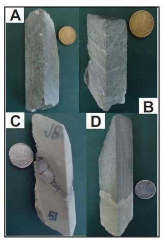
Figura 6 - Aspectos mesoscópicos dos dacitos presentes no Alvo Enche Concha. A) Dacito com coloração cinza claro; B) Dacito com alteração carbonática parcial; C) Dacito com alteração carbonática intensa, cortado por vênula de quartzo; D) Dacito cortado por vênulas de quartzo.
