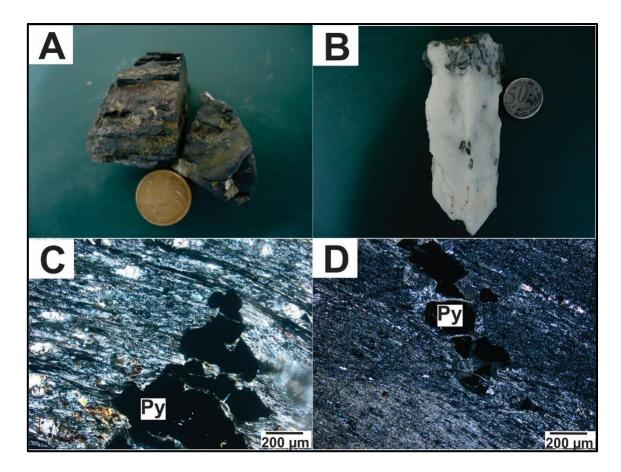
Figura 12 - Sulfetação presente no Alvo Enche Concha. As imagens de lâmina estão com nicóis cruzados. A) Aspectos mesoscópico dos sulfetos associados a filitos. B) Aspectos mesoscópicos de sulfetos associados a veios de quartzo. C) Cristais de pirita associados a filitos em zonas de intensa deformação dúctil. D) Cristais de pirita associados a vênulas de quartzo em filito com forma preservada, pouco afetada pela deformação (Abreviatura: Py-pirita).
