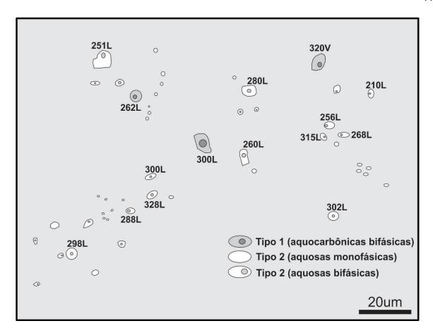
Figura 17 - Desenho feito à mão mostrando a distribuição e a relação textural entre os diferentes tipos de inclusões fluidas presentes no alvo Enche Concha em uma FIA (Amostra JB 08 - 75,45-75,55 m – Fragmento 3). O número próximo as inclusões indica a temperatura de homogeneização final (L para líquido e V para vapor).
