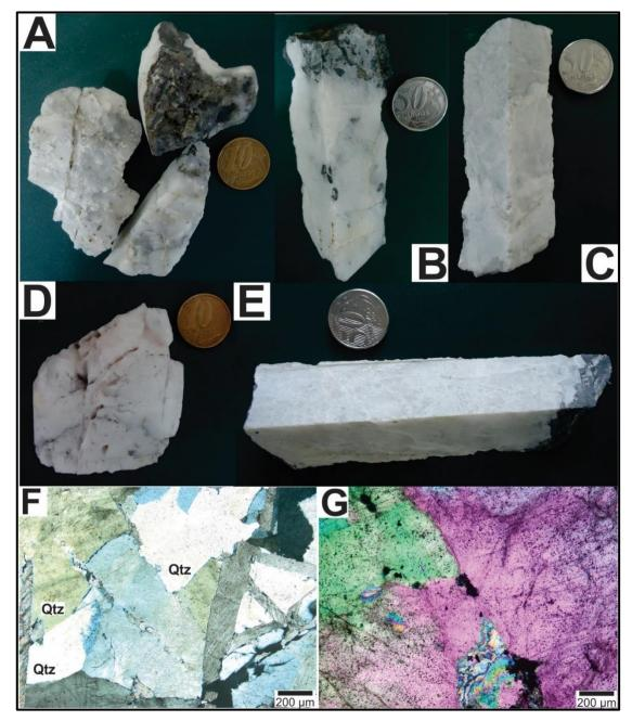
Figura 14 - Aspectos mesoscópicos e microscópicos das amostras de veios e vênulas de quartzo estudadas. A) e B) Cristais de quartzo com porções de rocha encaixante e fases sulfetadas; C) e D) Cristais de quartzo com vênulas de carbonato; E) Cristal de quartzo com porções de rocha encaixante sem fases sulfetadas; F) Cristais de quartzo anédricos em nicóis cruzados; G) Cristais de quartzo com bordas irregulares em nicóis cruzados e polarizador. (Abreviatura: Qtz- quartzo).
