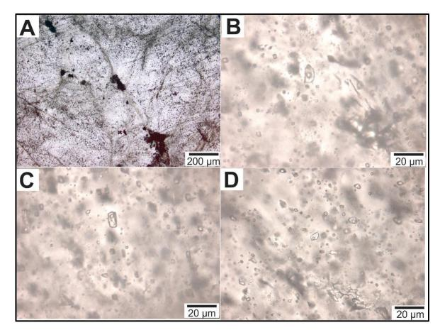
Figura 15 - Aspectos microscópicos das inclusões fluidas no Alvo Enche Concha. A) Cristal de quartzo com a presença de trilhas de inclusões e inclusões menores dispersas representadas por pontos escuros. B) Ocorrência de inclusão fluida do Tipo 1 de forma isolada em coexistência com inclusões do tipo 2 monofásicas; C) Inclusão bifásica do tipo 2 associada a inclusões monofásicas do tipo 2. D) Inclusões do tipo 2 que ocorrem em grupo e em trilhas.
