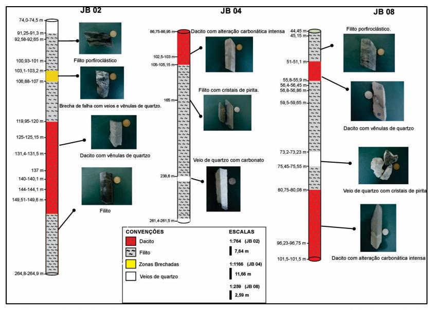
Figura 3 - Perfis esquemáticos dos furos de sondagem JB-02, JB-04 e JB-08 do alvo Enche Concha, mostrando a distribuição das principais litotipos hospedeiros.
