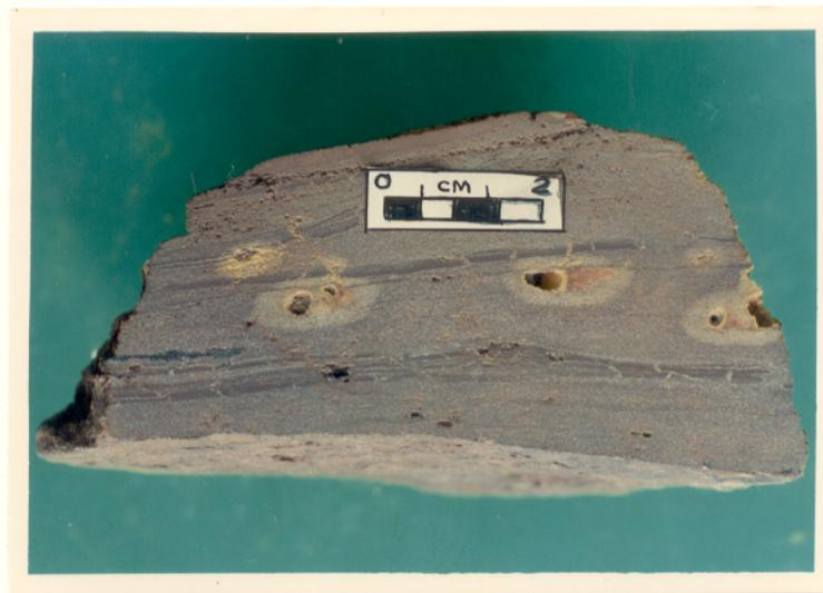
Foto 4.10 Bauxita laminada do perfil da Faz. João Bernardo. Pequenas cavidades mostram uma auréola esbranquiçada, de deferrificação. Amostra 1/1.
