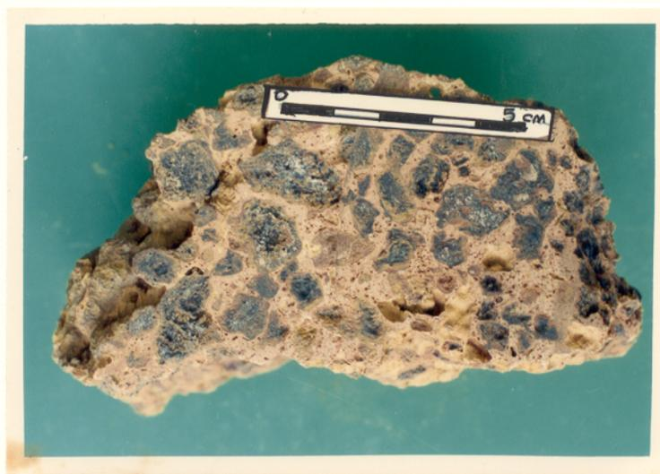
Foto 4.8 Bauxita de textura brechóide do horizonte superior. Os fragmentos são gibbsita-pirolusita-hematíticos e a matriz gibbsítica. Amostra 4/2b.
