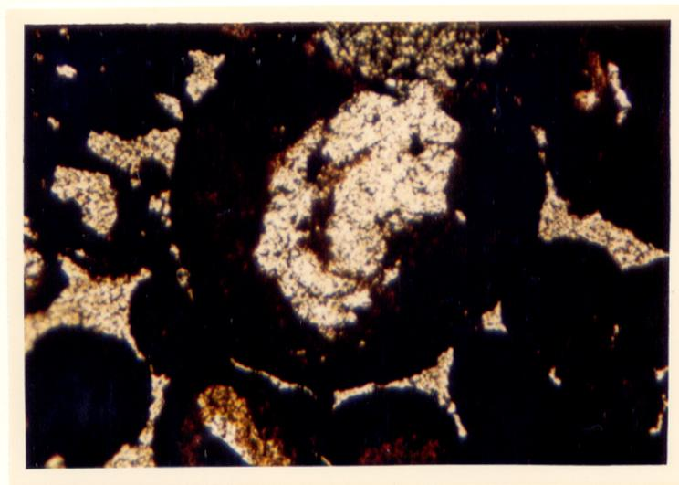
Foto 4.24 Pseudo-oolitos hematíticos. Aquele maior apresenta núcleo gibbsítico com relíctos de material hematítico. Lâmina 4/3;; n//; 25x.
