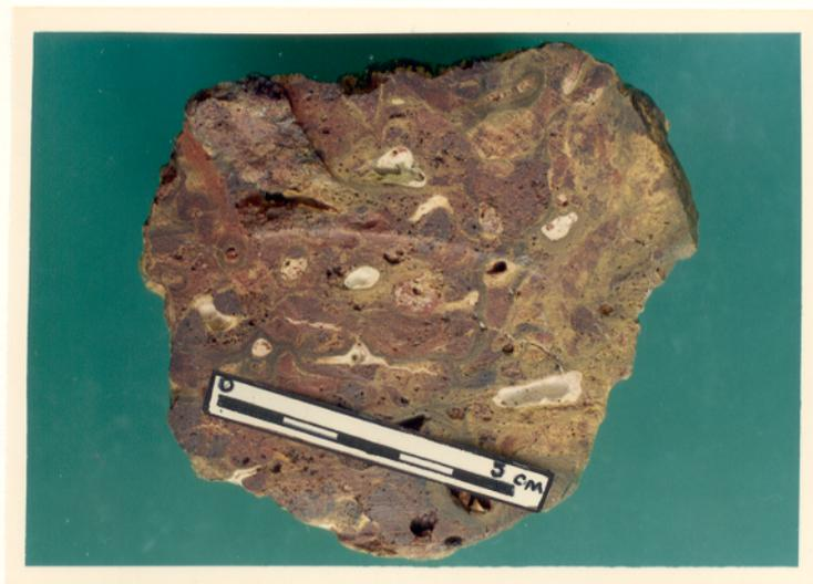
Foto 4.20 Cavidades revestidas por material gibbsita-caolinítico na zona de obliteração de textura conglomerática. Amostra 1/11a.
