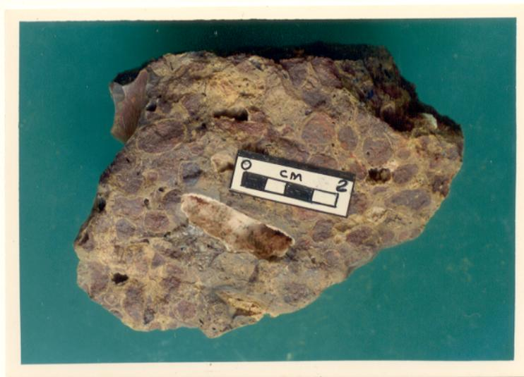
Foto 4.6 Bauxita pseudo-pisolítica do horizonte superior, apresentando cavidade revestida por gibbsita grosseira. Os elementos figurados são gibbsita-hematíticos e a matriz é gibbsita-goetita-hematítica. Amostra 4/3.
