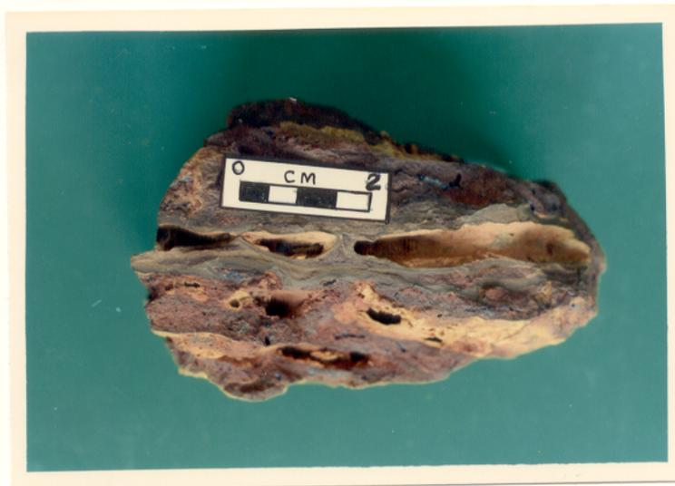
Foto 4.11 Bauxita grosseiramente bandada do perfil Faz. João Bernardo. A estrutura é dada pela alternância de níveis gibbsita-caoliníticos, porosos ou cavernosos, e outros mais hematíticos. Depósitos cutânicos são frequentes. Amostra 1/2.
