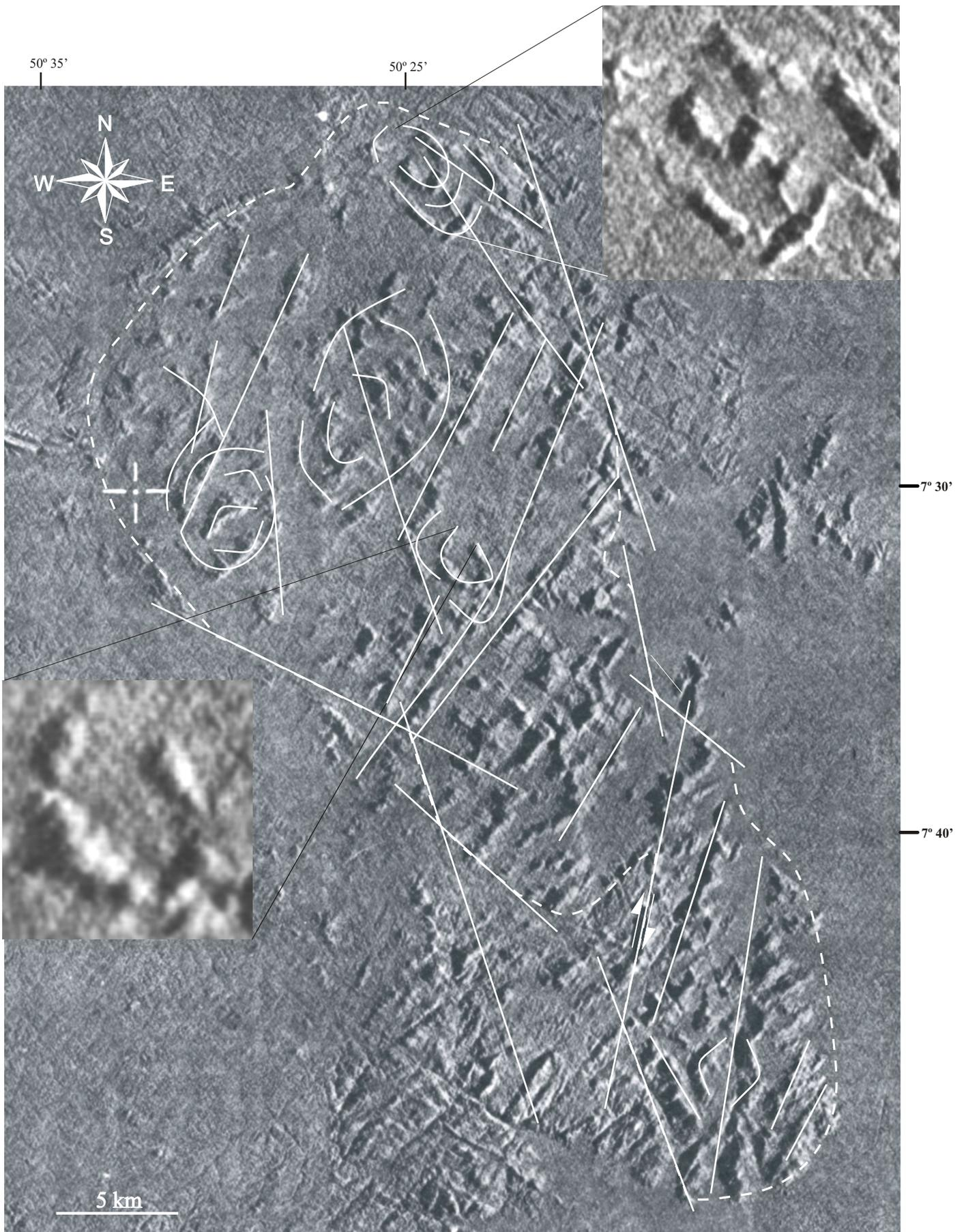
**Figura 2.2-** Imagem de radar, mostrando uma visão geral do Granito Bannach, que se distingue de suas rochas encaixantes pelo relevo mais expressivo e pelas cristas alinhadas na direção NE-SW e por apresentar fraturamento intenso. Notar a presença de estruturas circulares no interior do corpo, destacadas em ampliações da imagem.
