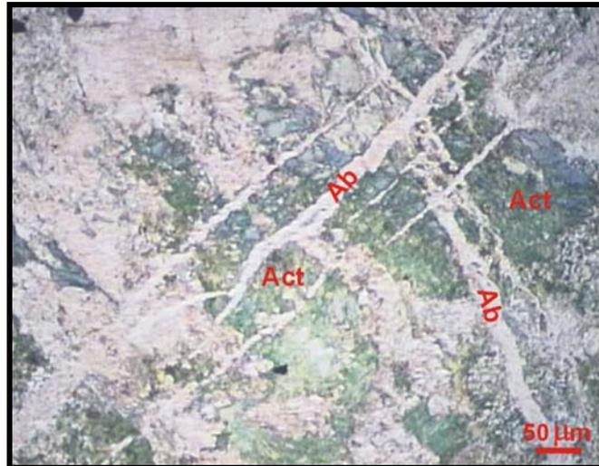
**Figura 41:** Fotomicrografia de cristais anédricos de actinolita (Act) cortados por vênulas de albita (Ab) em rochas graníticas (Amostra FD-314/118,4m – Luz transmitida, Nicóis //, 2,5x) (Fonte Sousa, 2004).
