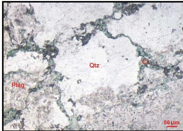
**Figura 44:** Fotomicrografia de granito em que a clorita (Cl) ocorre ocupando os espaços intergranulares entre os cristais de plagioclásio (Plag) e quartzo (Qtz) (Amostra FD-266/55m – Luz transmitida, Nicóis //, 10x).
