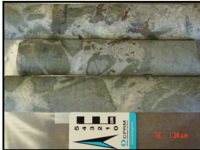
**Figura 32:** Fotografia de testemunho de sondagem do furo 380/122,40-197,75m, correspondendo a brechas constituídas de clastos de rocha máfica hidrotermalizada de tamanhos variados. Esses clastos estão bastante cloritizados, normalmente apresentam coroa de magnetita nas bordas e acham-se cimentados por calcita (Corpo Sossego).
