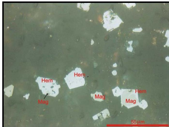
**Figura 38:** Fotomicrografia de martitização (parcial e total), em que aparecem cristais de hematita (Hem) pseudomorfos da magnetita (Mag) nos IAC (Amostra FD-266/437m – Luz refletida, Nicóis X, 40x).
