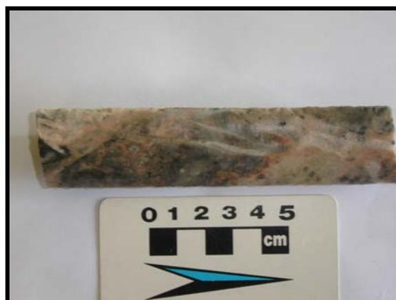
**Figura 15:** Fotografia de testemunho de sondagem do furo 266/473,3, correspondendo à variedade MVA albitizada (corpo Sequeirinho).
