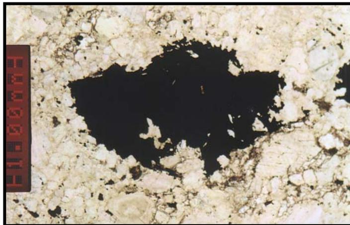
**Figura 22:** Fotomicrografia de cristal de magnetita nos actinolititos apresentando as bordas corroídas pela substituição da actinolita (Amostra FD-352/93,8m– Luz transmitida, Nicóis //, 5x).
