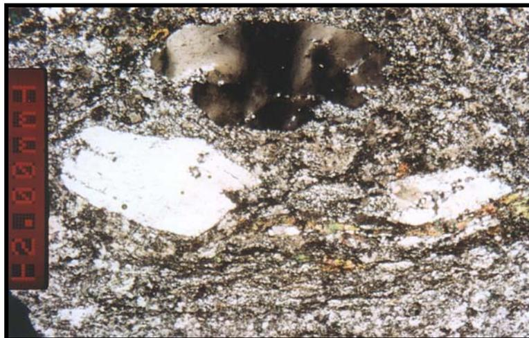
**Figura 24:** Fotomicrografia da textura porfiroblástica, em que cristais de quartzo encontram-se imersos em uma matriz fina acompanhando os planos de foliação milonítica das BIX (Amostra FD-352/154, 1m – Luz transmitida, Nicóis X, 2,5x).
