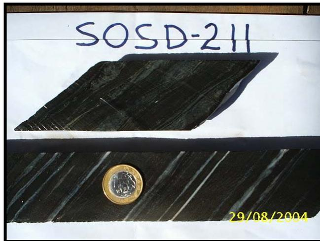
**Figura 23:** Fotografia de testemunho de furo de sondagem (Amostra 211/87,03m) correspondente à rocha rica em biotita, ressaltando o bandamento milimétrico caracterizado pela alternância de bandas claras ricas em quartzo e/ou escapolita e escuras ricas em biotita, Cl-K-Fe-hastingsita e turmalina (Corpo Pista).
