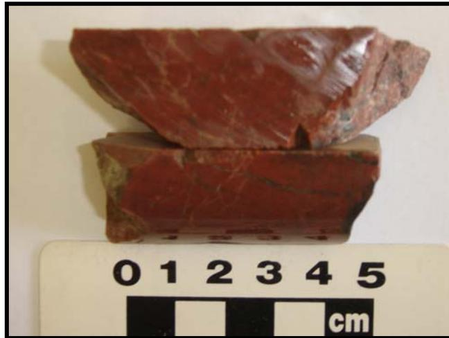
**Figura 35:** Fotografia de testemunho de furo de sondagem (37/344,90m) correspondendo a diques félsicos isotrópicos de coloração vermelho-tijolo, de granulometria fina com vênulas de quartzo (Corpo Sequeirinho).
