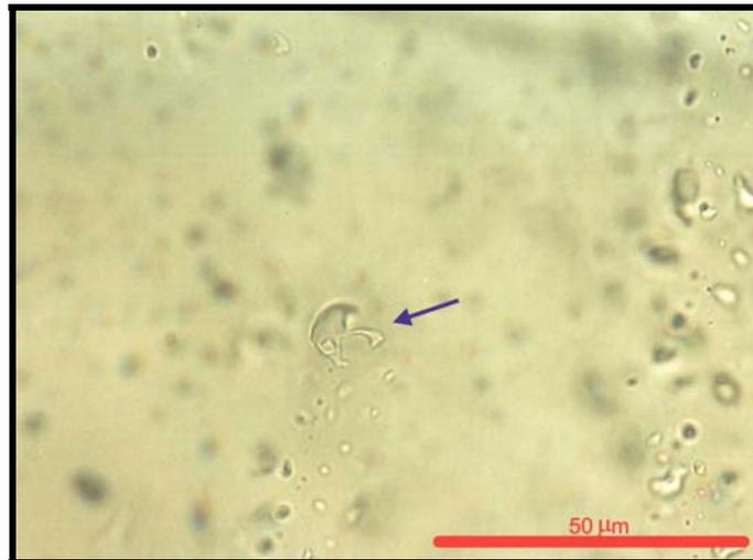
**Figura 62:** Fotomicrografia de IF tipo L+S em cristais de quartzo do GRA, indicando que sofreram processo de estrangulamento após a separação das fases (Amostra: F-380/179,2-179,3m-2 – 50x).
