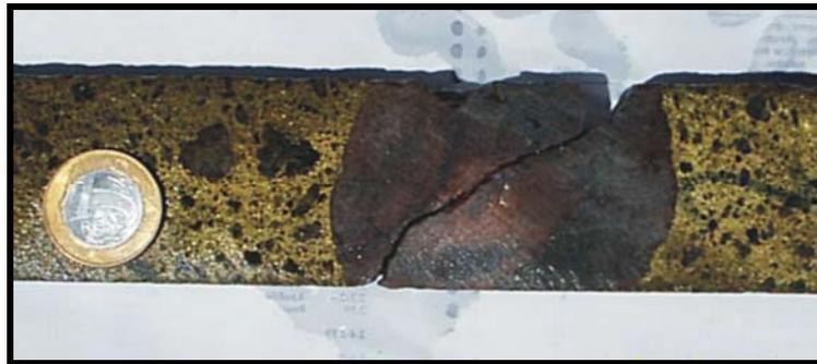
**Figura 6:** Fotografia de testemunho de sondagem do furo 246/608,20-608,5m, correspondendo a brecha composta de clastos, arredondados a subarredondados, de rochas granitóides, imersos em matriz muito rica em calcopirita (Corpo Sequeirinho).
