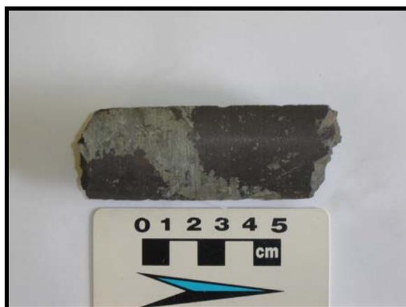
**Figura 26:** Fotografia de testemunho de furo de sondagem (Amostra 33/364,1m) correspondente a magnetitito. Notar concentrações de minerais verdes (clorita + actinolita + epidoto) associadas à magnetita (parte escura) (Corpo Sequeirinho).
