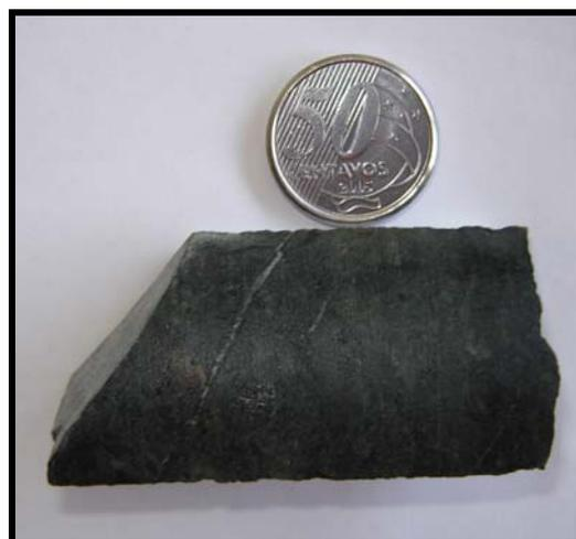
**Figura 21:** Fotografia de testemunho de furo de sondagem (Amostra 352/93,8m) correspondente a actinolitito de coloração cinza esverdeado (Corpo Sequeirinho).
