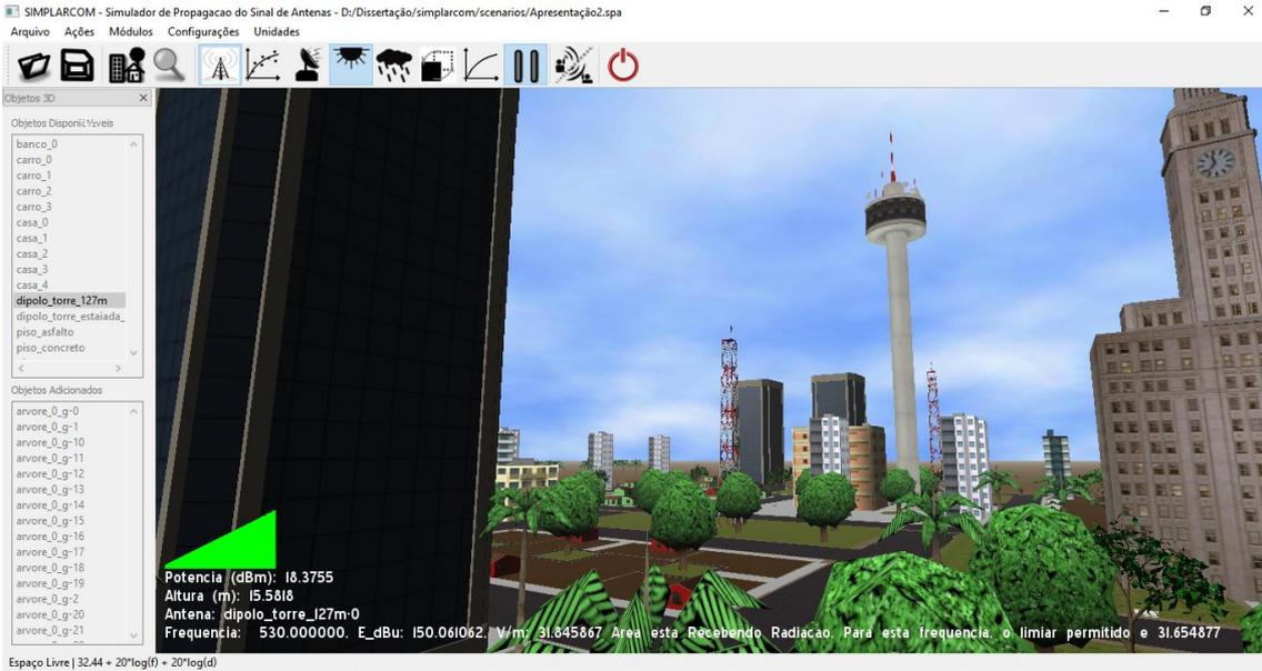
Figura 6. 9. Área recebendo radiação para a faixa de 400Mhz e 2000MHz
