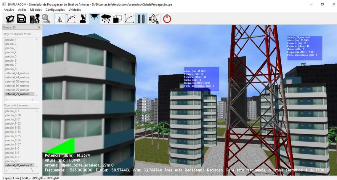
Figura 6. 18. Área recebendo radiação de acordo com as configurações da antena de transmissão da Fundação Nazaré de Comunicação
