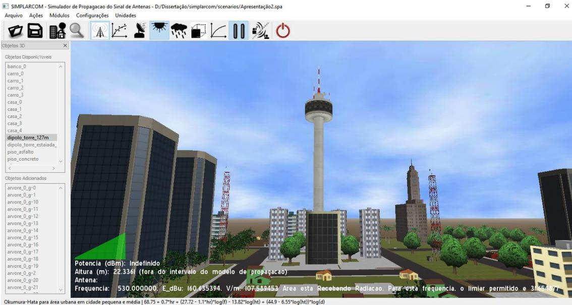
Figura 5. 8. Altura fora do limite e área sendo considerada exposta
