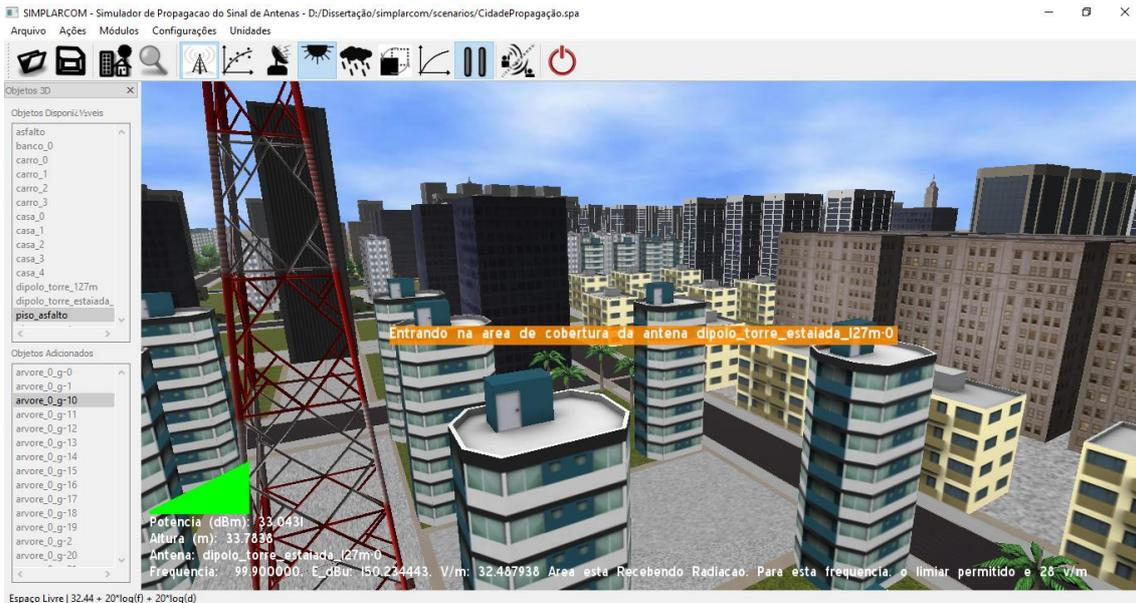
Figura 6. 16. Área recebendo radiação de acordo com as configurações da antena de transmissão da Carajás FM LTDA
