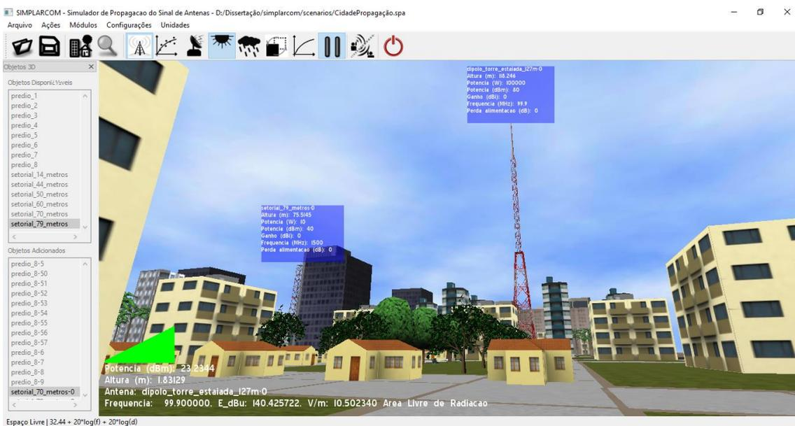
Figura 6. 17. Área livre de radiação de acordo com as configurações da antena de transmissão da Carajás FM LTDA
