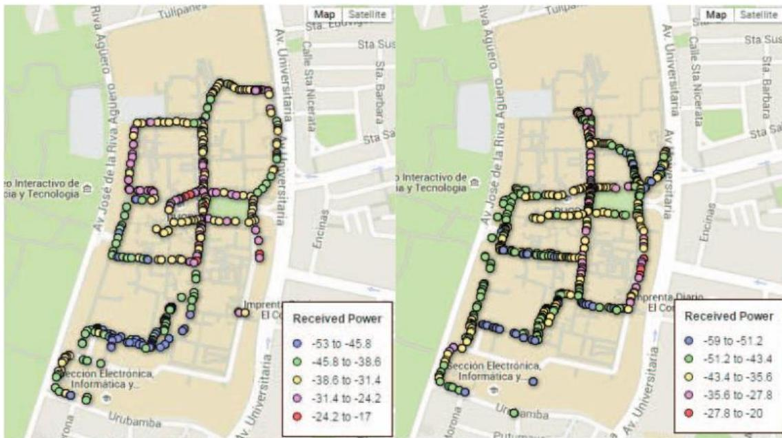
Figura 3. 1. Representação do nível de potência para *downlink* de 850 MHz e 950 MHz (PRADO e MANUEL, 2015)
