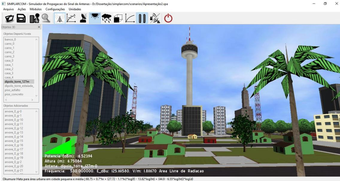
Figura 6. 11. Área livre de radiação segundo o modelo Okumura-Hata
