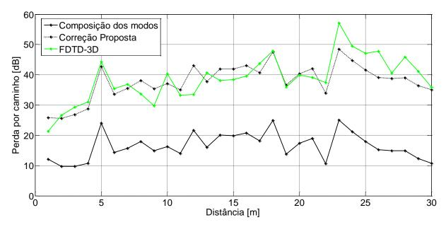
Figura 6.9 Correção proposta da perda por caminho através da composição dos modos TEy e TMz.
