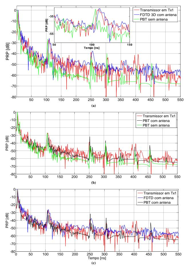
Figura 6.5 Comparação do perfil de retardo de potência entre dados experimentais e os métodos FDTD 3D e PBT.
