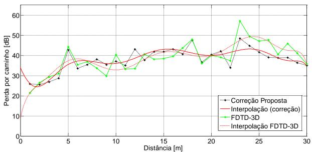
Figura 6.11 Interpolação das curvas gerados pelos métodos FDTD-2D e 3D.
