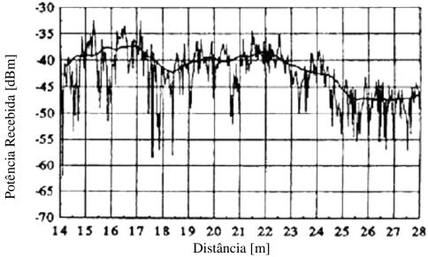
Figura 2.1 Características de um canal rádio-móvel típico [3].
