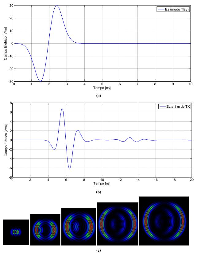
Figura 3.5 Campo elétrico calculado no modo TEy nos pontos de transmissão (Tx) e recepção (Rx1).
