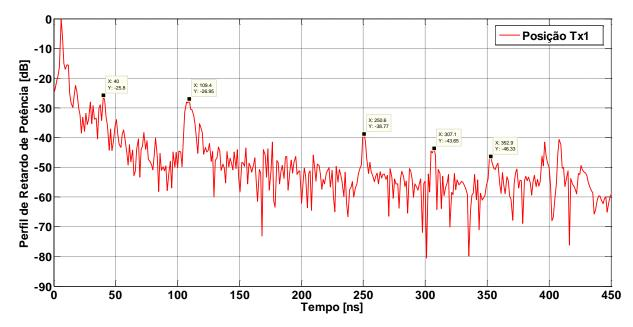
**Figura 6.4** Perfil de retardo de potência medido considerando a posição do transmissor (Tx1) a 1 m do receptor (Rx), no corredor mostrado na Figura 6.1.
