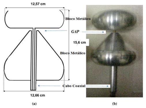
Figura 5.1 Antena utilizada nas medições. (a) Geometria da antena e (b) Fotografia da antena discônica.
