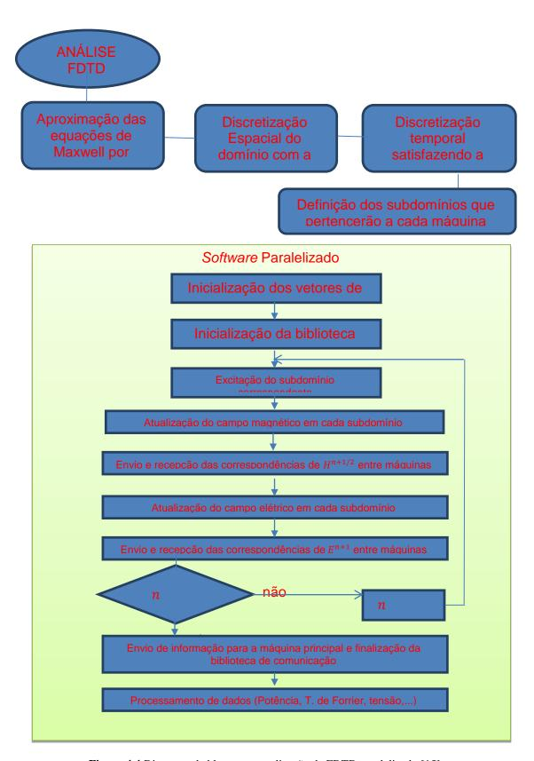
Figura 4.4 Diagrama de blocos com aplicação de FDTD paralelizado [15].
