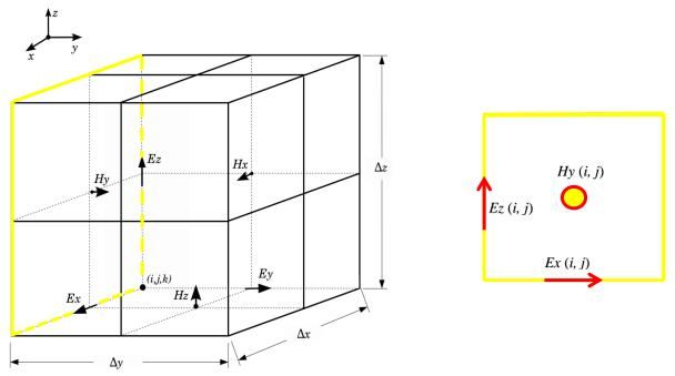
Figura 2.6 Distribuição geométrica das componentes do modo TEy na célula bidimensional de Yee.
