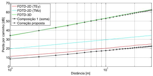
Figura 3.11 Correção para a composição dada pela soma dos campos elétricos nos modos TMz e TEy.
