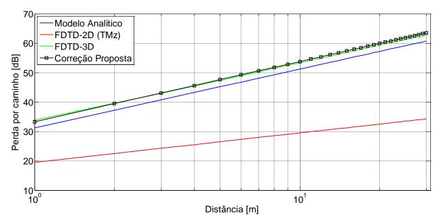
Figura 3.2 Correção proposta ao método FDTD-2D, no modo TMz.
