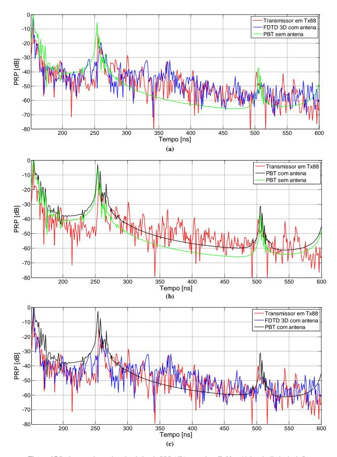
Figura 6.7 Dados experimentais e simulados do PRP (dB) na posição Tx88, a 44,5 m de distância de Rx.
