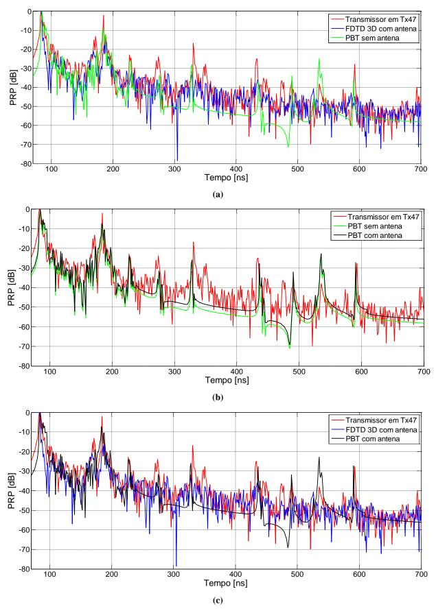
**Figura 6.6** Comparação entre dados medidos e simulados do PRP (dB) do sinal proveniente da posição Tx47, a 24 m de distância de Rx.
