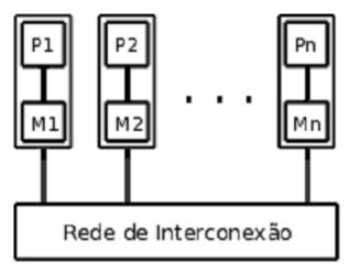
**Figura 4.3** Arquitetura paralela na configuração de multicomputadores [19].
