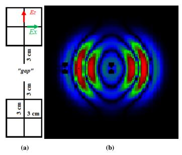
**Figura 3.4** Representação da antena em FDTD-2D. (a) Geometria e (b) imagem da propagação de um pulso no "gap" da antena.
