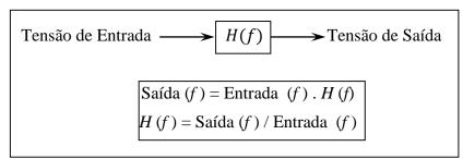
**Figura 2.3** Diagrama de blocos ilustrando a operação linear de obtenção da função de transferência H (f).
