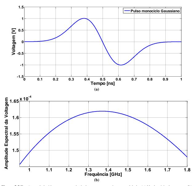
**Figura 5.5** Tensão estabelecida entre os terminais da antena transmissora modelada. (a) No domínio do tempo e (b) no domínio da frequência.
