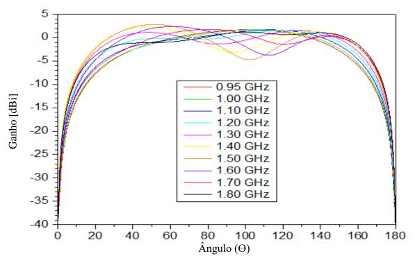
Figura 5.2 Ganho da antena discônica para várias frequências utilizando o método dos momentos adaptado de [8].
