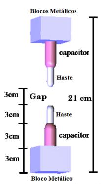
Figura 5.7 Representação computacional na malha uniforme utilizando o método FDTD 3D.
