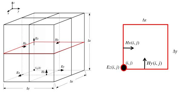
Figura 2.5 Distribuição geométrica das componentes do modo TMz na célula bidimensional de Yee (adaptado de [14].
