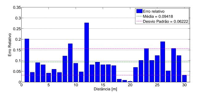
**Figura 6.10** Erro relativo, média e desvio padrão do erro referentes aos valores da perda por caminho utilizando os métodos FDTD-2D com correção e o método FDTD-3D.
