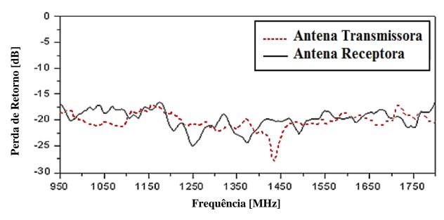
Figura 5.3 Medida da perda de retorno da antena discônica [34].
