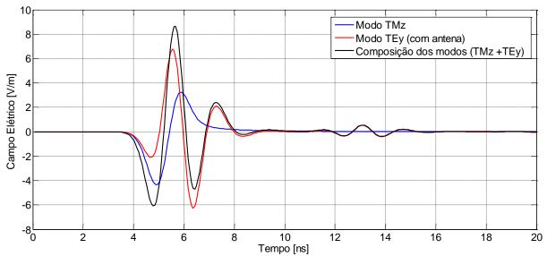
Figura 3.7 Composição dos modos TMz e TEy a 1 m do transmissor.
