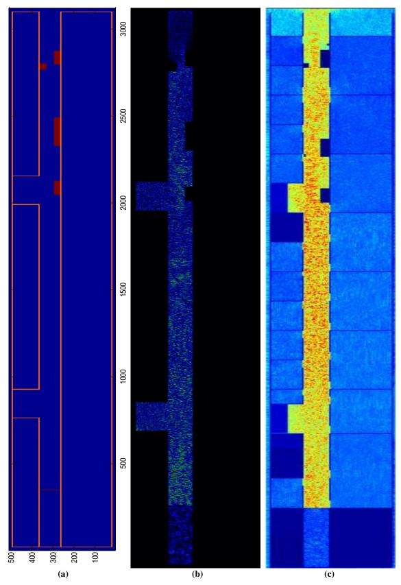
**Figura 6.13** Propagação do campo elétrico no ambiente computacional. (a) Representação computacional em duas dimensões do ambiente interior. (b) Propagação do campo elétrico através do método FDTD-2D, modo TMz. (c) Propagação do campo elétrico através do método FDTD-3D, num plano horizontal na altura do "gap" das antenas.
