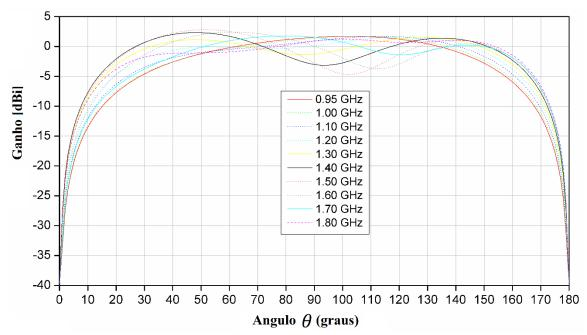
Figura 5.8 Ganho da representação em FDTD da antena discônica obtido com capacitores de 0,5 μF.
