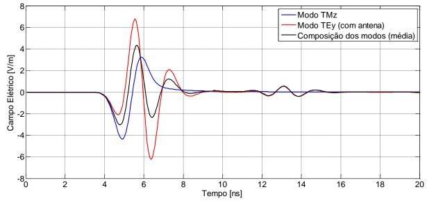
**Figura 3.8** Composição dos modos TMz e TEy a 1m do transmissor. Composição a partir da média entre os primeiros pulsos TMz e TEy no receptor.
