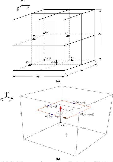
**Figura 2.4** Célula de *Yee*: (a) Componentes do campo eletromagnético dispostos na célula de *Yee*; (b) Componentes do campo magnético circulando ao redor da componente na direção *z* do campo elétrico (adaptadas de [14]).
