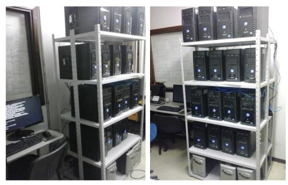
Figura 4.1 Cluster "Amazonia" do laboratório de nanoeletrônica e nanofotônica.
