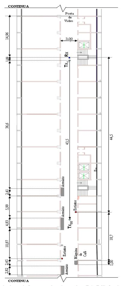
**Figura 6.2** Planta baixa do corredor Leme e as posições do transmissor (Tx1 e Tx88). Os valores das dimensões estão em metros.
