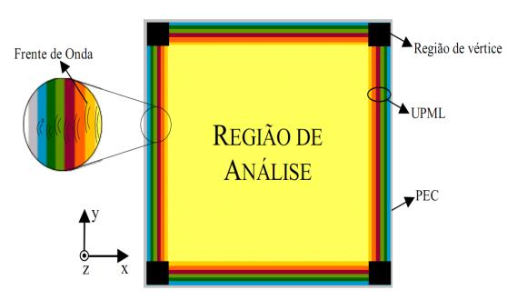
Figura 2.7 Imagem que mostra a truncagem da malha usando a UPML em um plano [14, 15].
