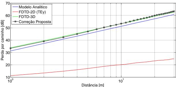
Figura 3.6 Correção proposta para a equivalência das perdas entre os métodos FDTD-2D e FDTD-3D.
