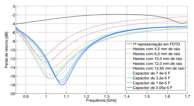
Figura 5.6 Perdas de retorno das representações em FDTD da antena discônica.
