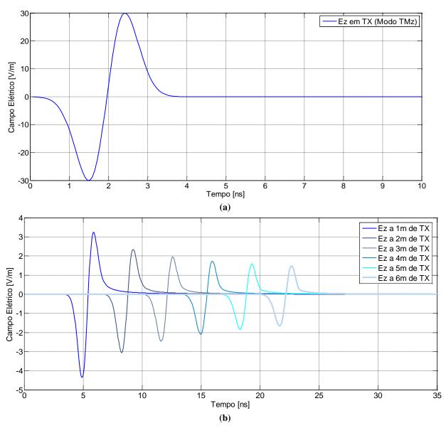
Figura 3.3 Campo elétrico calculado no modo TMz nos pontos de transmissão e recepção.
