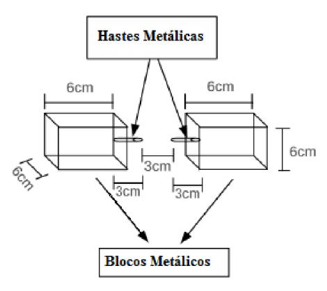
Figura 5.4 Primeira representação da antena discônica na malha uniforme utilizando o método FDTD-3D.
