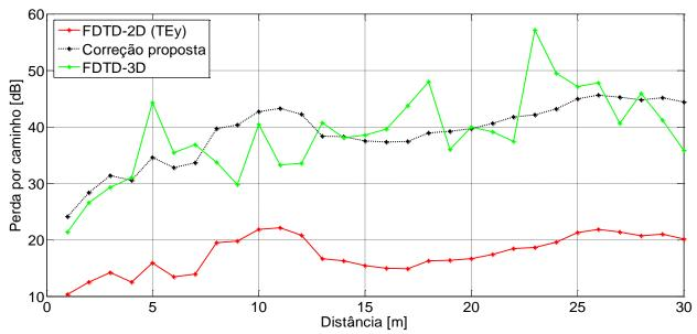
Figura 6.12 Perda por caminho calculada com o método FDTD-2D, modo TE, e correção proposta.
